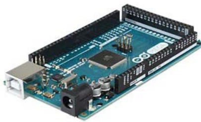
Figura 5.5: MCU Arduino Mega 2560 R3 (Reichelt Elektronik GmbH & Co., 2016)
