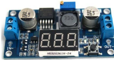
Figura 5.8: Regulador conmutado LM2596S (HeTPro, 2016)
