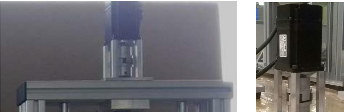
Imagen 27. Servomotor Yaskawa® SGMJV-04A3M61 usado como elemento motriz en el banco de pruebas en la primera iteración
