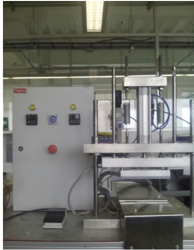
Imagen 43. Banco de pruebas de sellado térmico con una disposición de elemento distinto pero basado en el diseño conceptual del banco de pruebas desarrollado en este trabajo.
