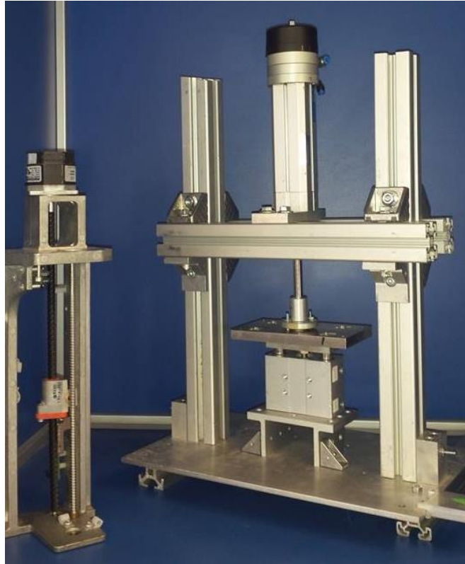
Imagen 9. Prototipos de funcionalidad limitada para banco de pruebas de sellado térmico y de tensión.
