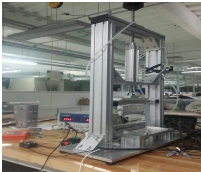
Imagen 23 Banco con circuito neumático y circuito eléctrico en fase 1 y fase 2
