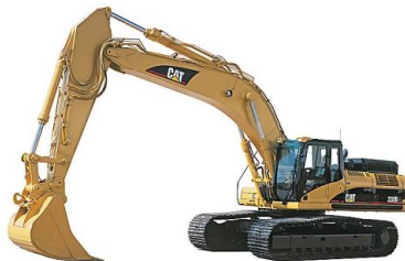
Figura 2.5: Excavadora 330D CAT
