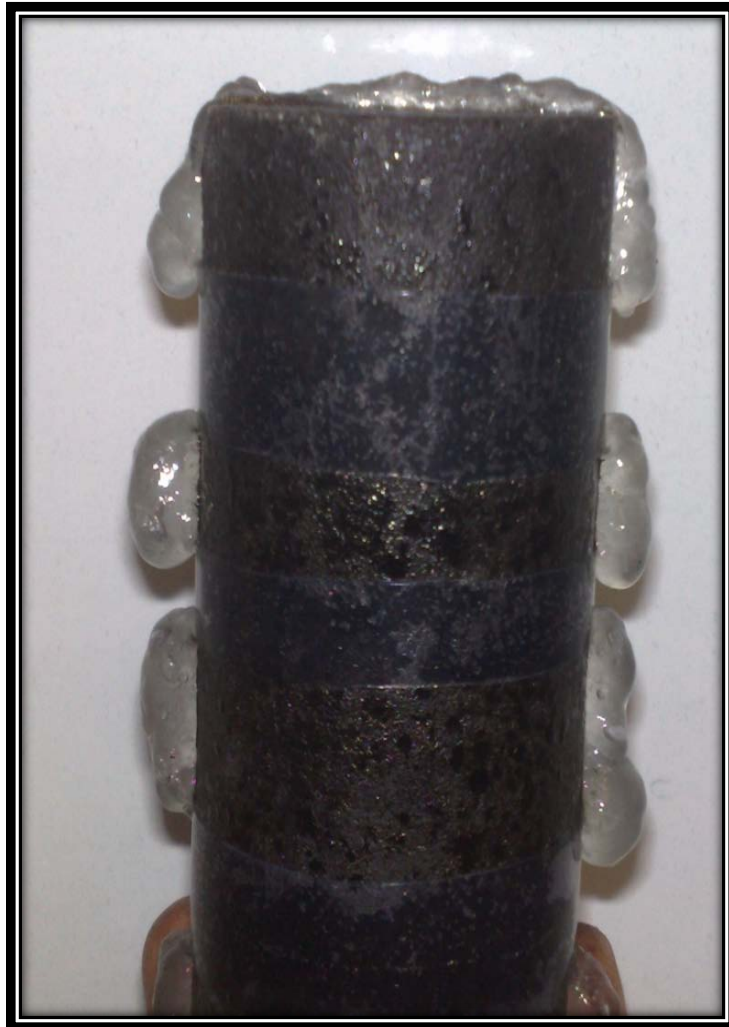
Figura 6.6. Gel implantado en la fractura del núcleo y confinado con tiras de plástico termoadherible.
