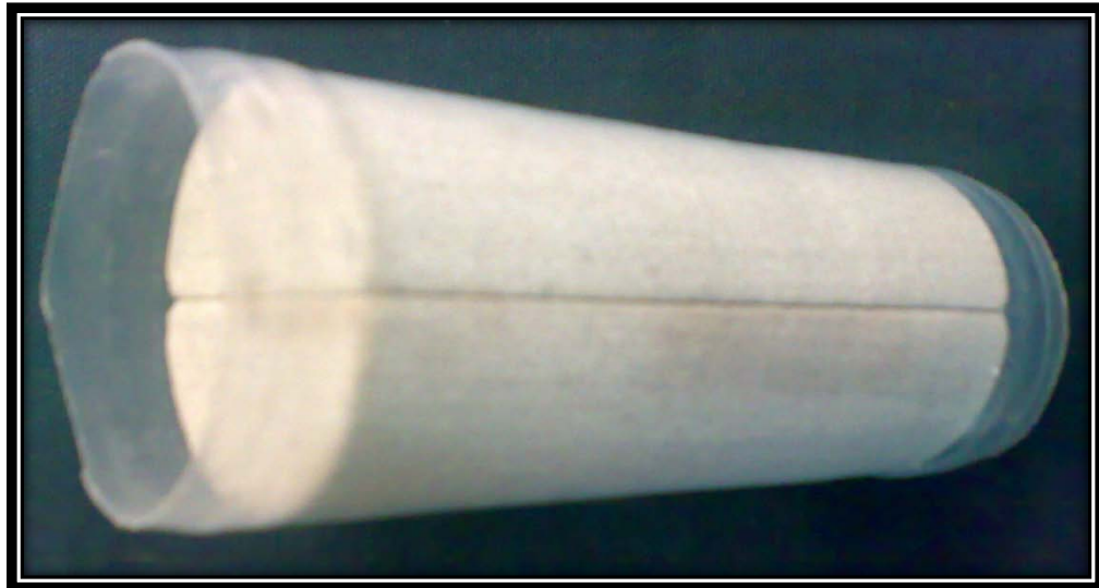
Figura 4.3. Núcleo enmangado con plástico termoadherible.
