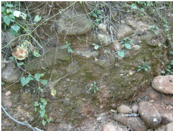
Fotografía 11. En la margen derecha están los depósitos de talud (Qdt), conformados por fragmentos de roca de formas subangulosas contenidos en una matriz arcillosa no consolidada.
