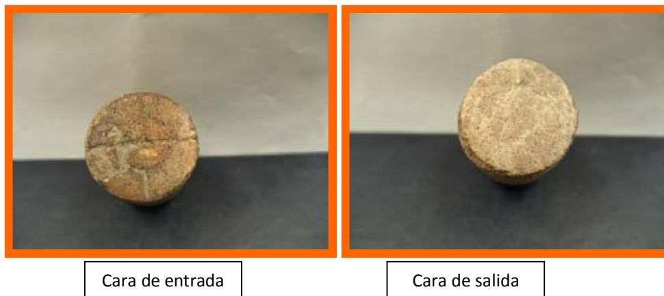
Figura 5.22 Efecto de la inyección del ácido sobre el núcleo saturado de agua. Ningún agujero de gusano es observado en la entrada y salida del núcleo.
