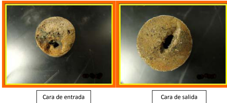
Figura 5.21 Efecto de la inyección del ácido sobre el núcleo saturado de aceite. Un gran agujero de gusano es visible en la entrada y salida del núcleo.
