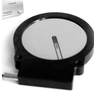
Figura 1.3. Hidrófono de membrana [1].
