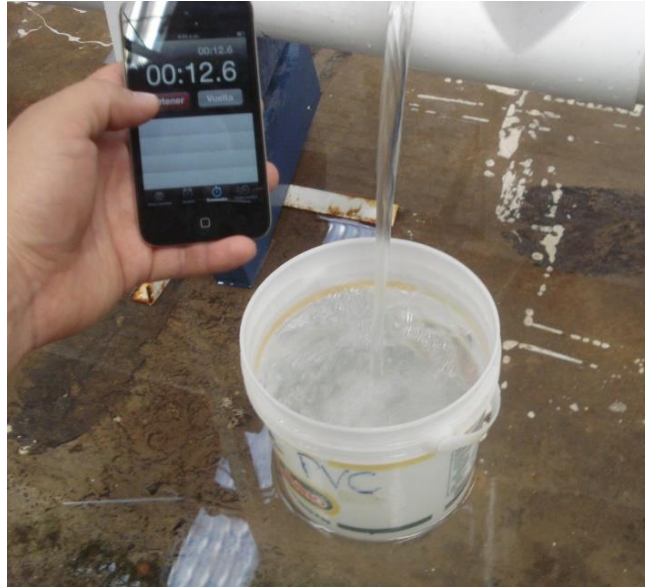
Figura 6. 15 Medición de gastos en cada toma
