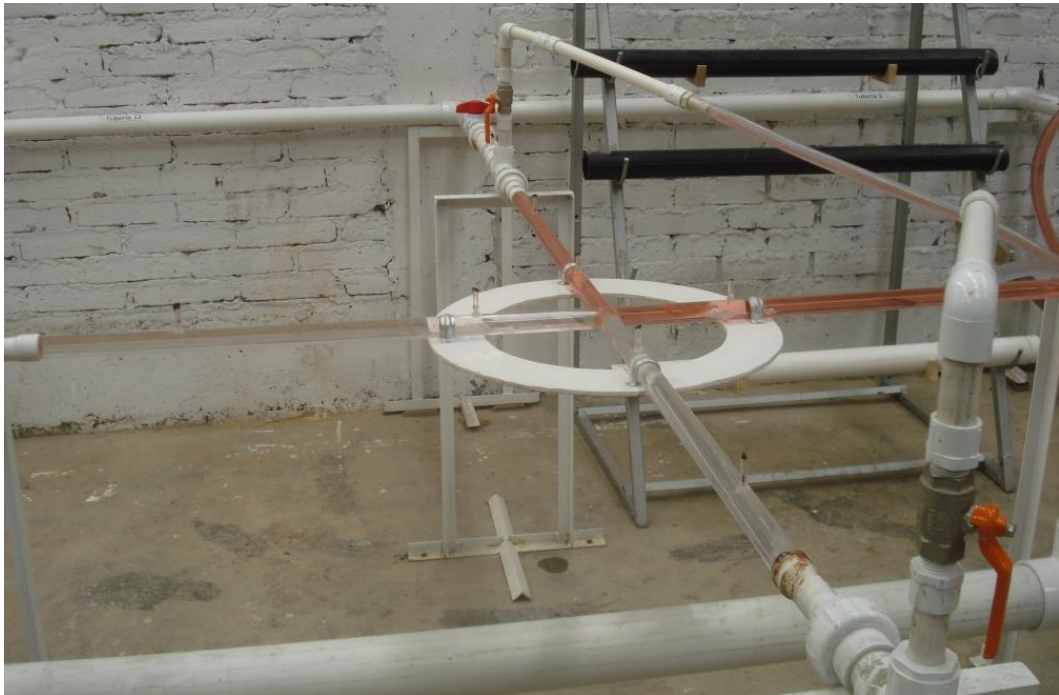
Figura 6. 8 Cruce de acrílico 1, sin mezcla de flujos (colorante)
