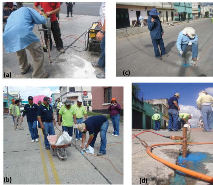
Figura 3.3. Tomografía eléctrica, Esquema que muestra la inserción de un electrodo de cobre en el suelo. (a) Perforación en el pavimento para que el electrodo se asiente en el suelo natural. (b) Se coloca una pequeña cantidad de sulfato de cobre y agua. (c) Se introduce el electrodo con la ayuda de un mazo asegurándose que quede fijo. (d) La parte del electrodo que sale a superficie, se conecta al cable inteligente que a su vez está conectado al equipo.
