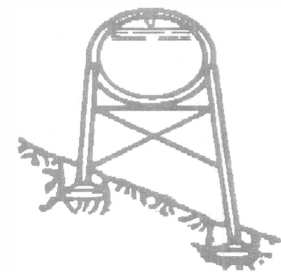
g) Acueducto cerrado de acero sobre caballetes
