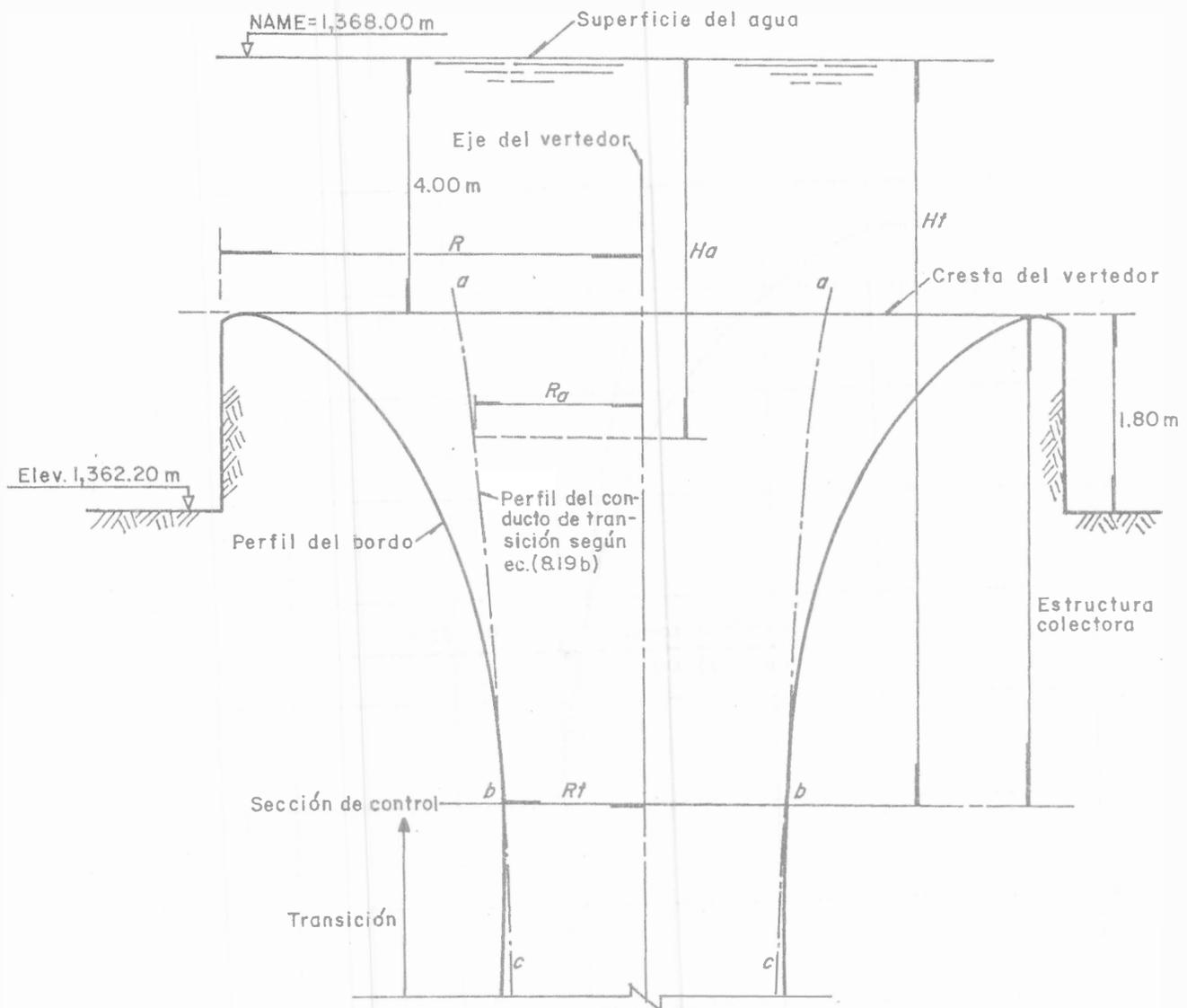
Figura 8.65. Dimensiones generales de la estructura colector del ejemplo 8.6 .
