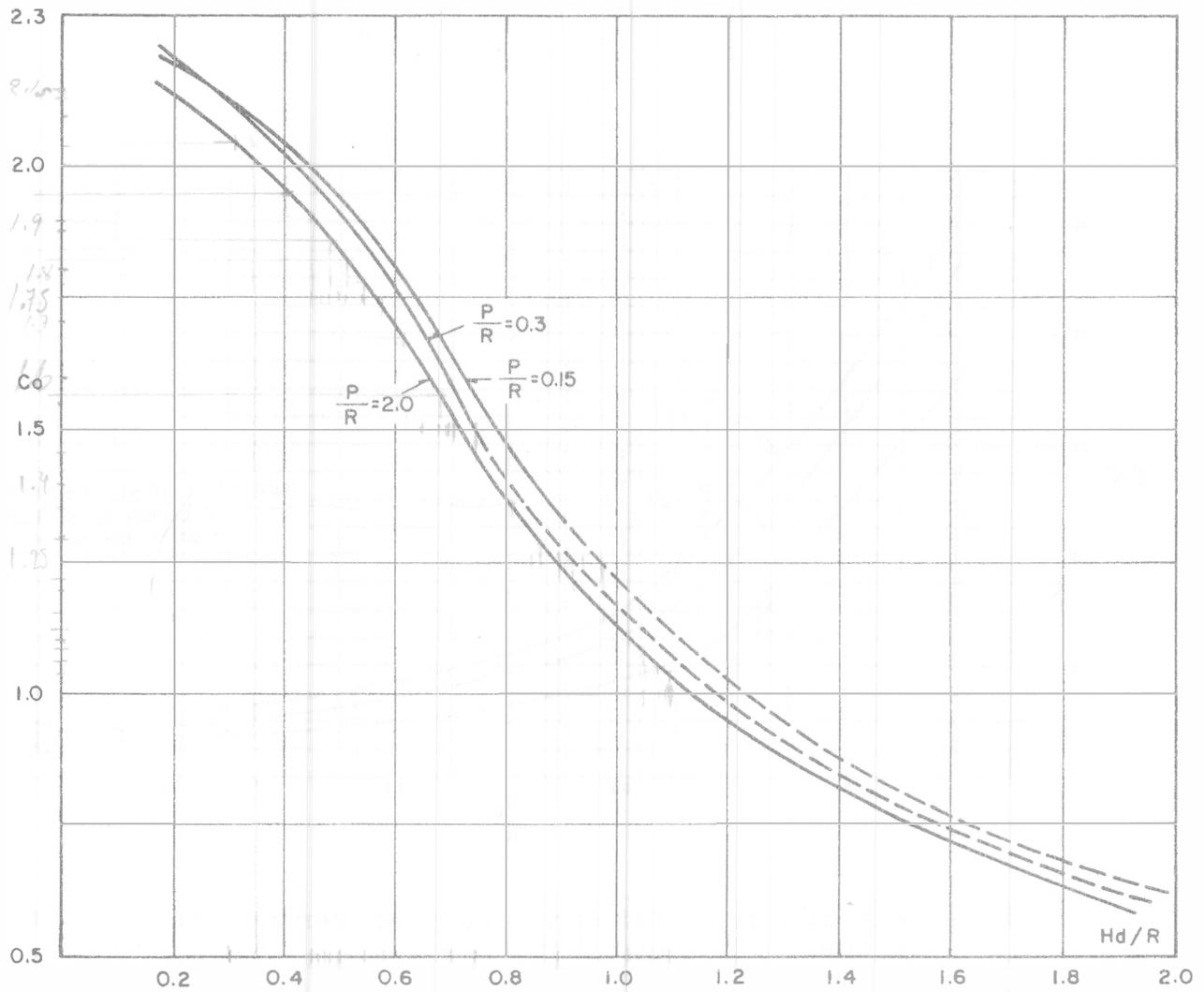
Fig. 8.55.- Coeficiente de descarga  $C_0$  de un vertedor de embudo para la carga de diseño (Ref. 79)
