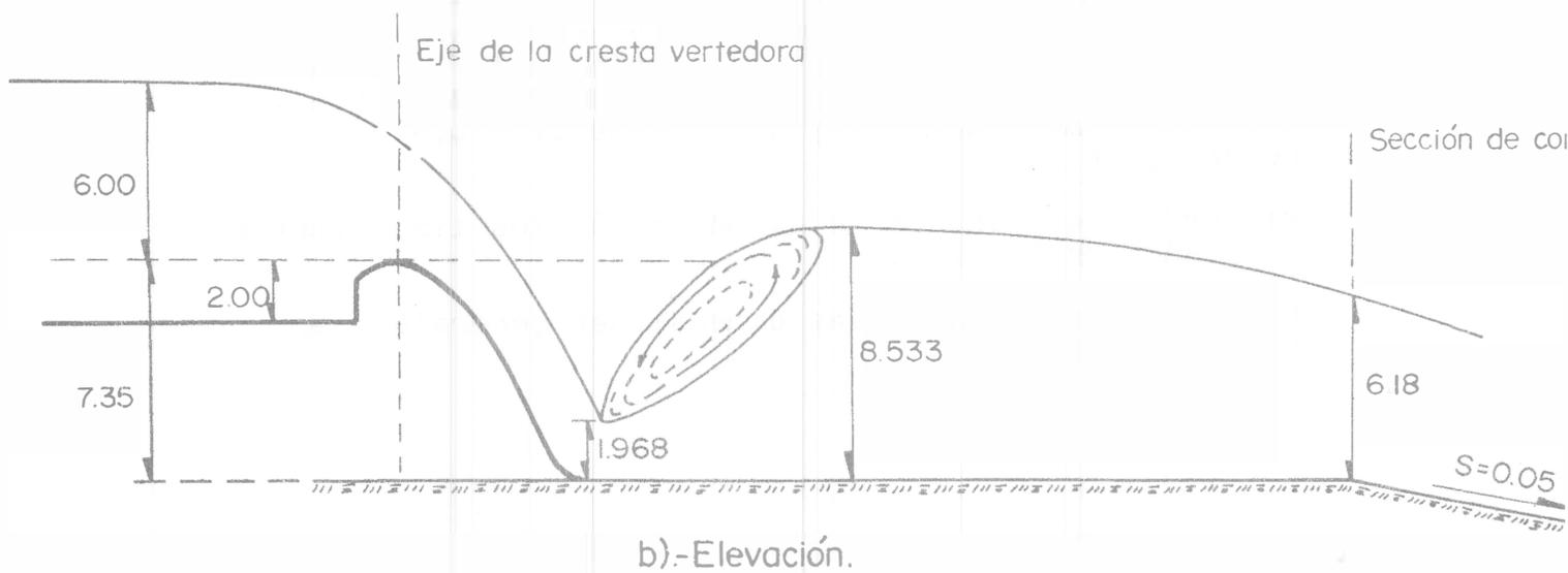
Fig. 8.46.- Dimensiones generales del vertedor de abanico en el ejemplo 8.4.
