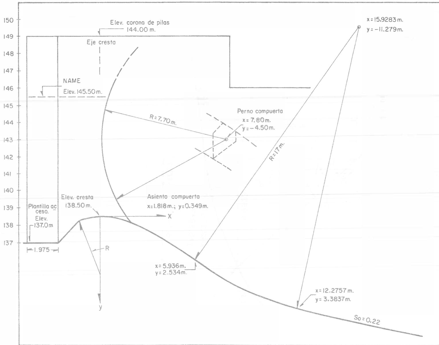
Fig. 8.42.- Perfil de la estructura de control en el ejemplo 8.3
