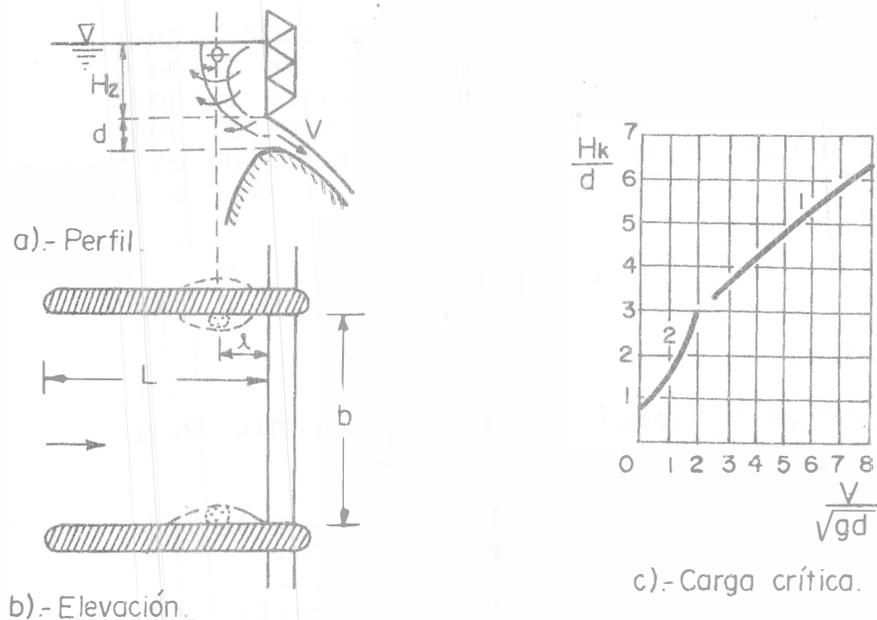
Fig. 8.33 Formación de vórtices aguas arriba de compuertas (ref. 32)
