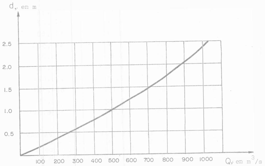
Fig. 8.37 Curva Abertura de compuerta - Gasto para el embalse a la Elev. 54.06, en el Ejemplo 8.2
