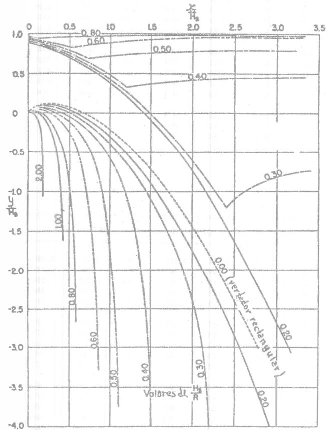
Fig. 8.58.- Perfiles superior e inferior de la lámina vertiente sobre un vertedor circular (ventilada y con velocidad de llegada despreciable) para  $P/R > 2$  (Ref. 79).
