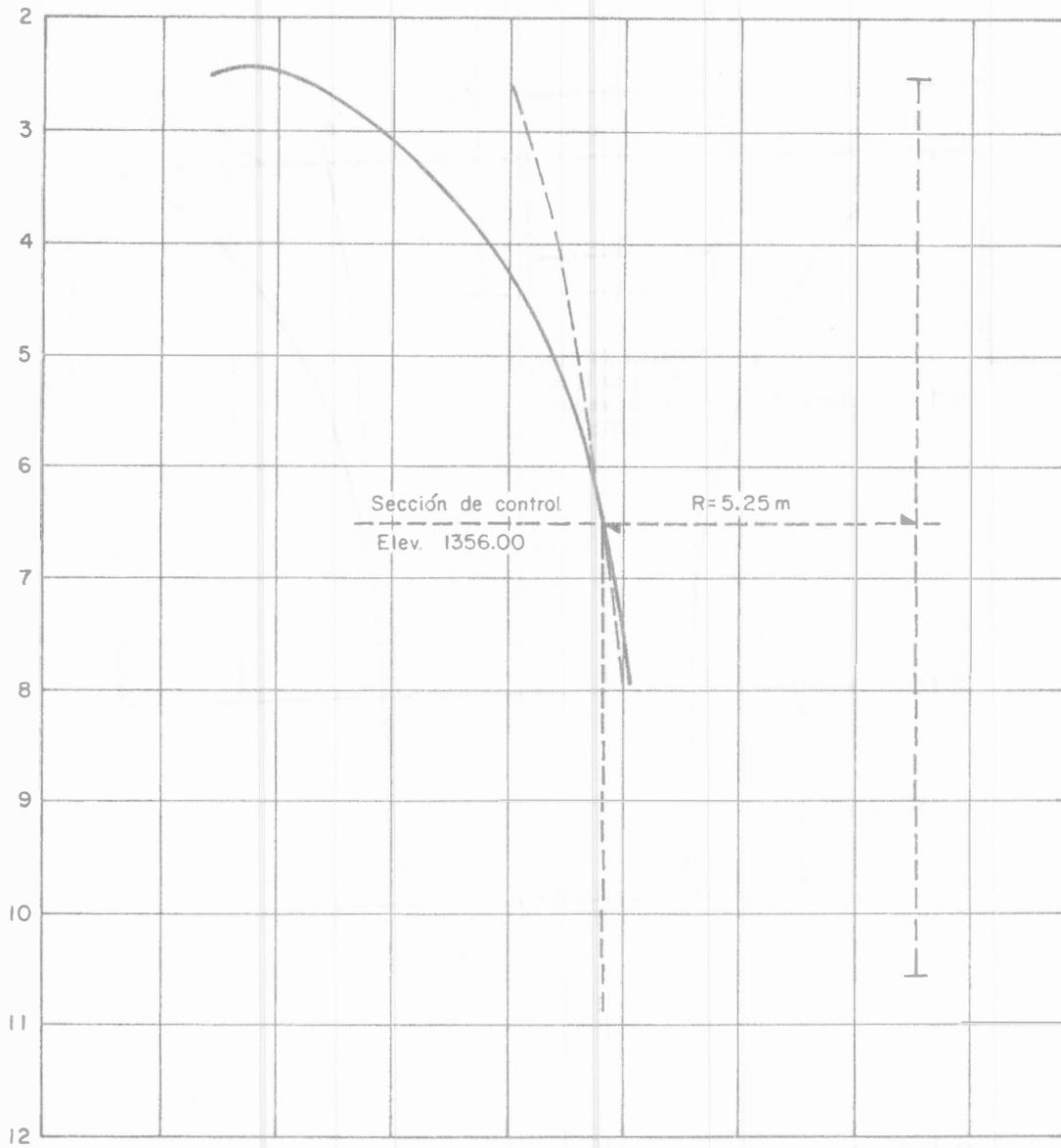
Fig. 8.64.- Ubicación de la sección de control, en el ejemplo 8.6.
