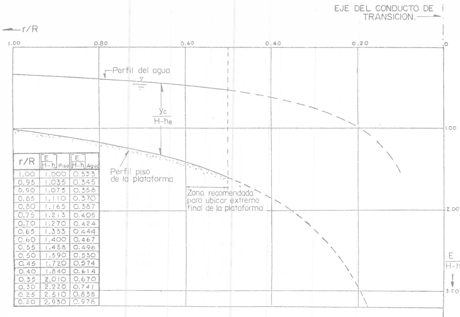
Fig. 8.62.- Perfiles piso de la plataforma y de la superficie del agua en términos adimensionales, para un vertedor de embudo.
