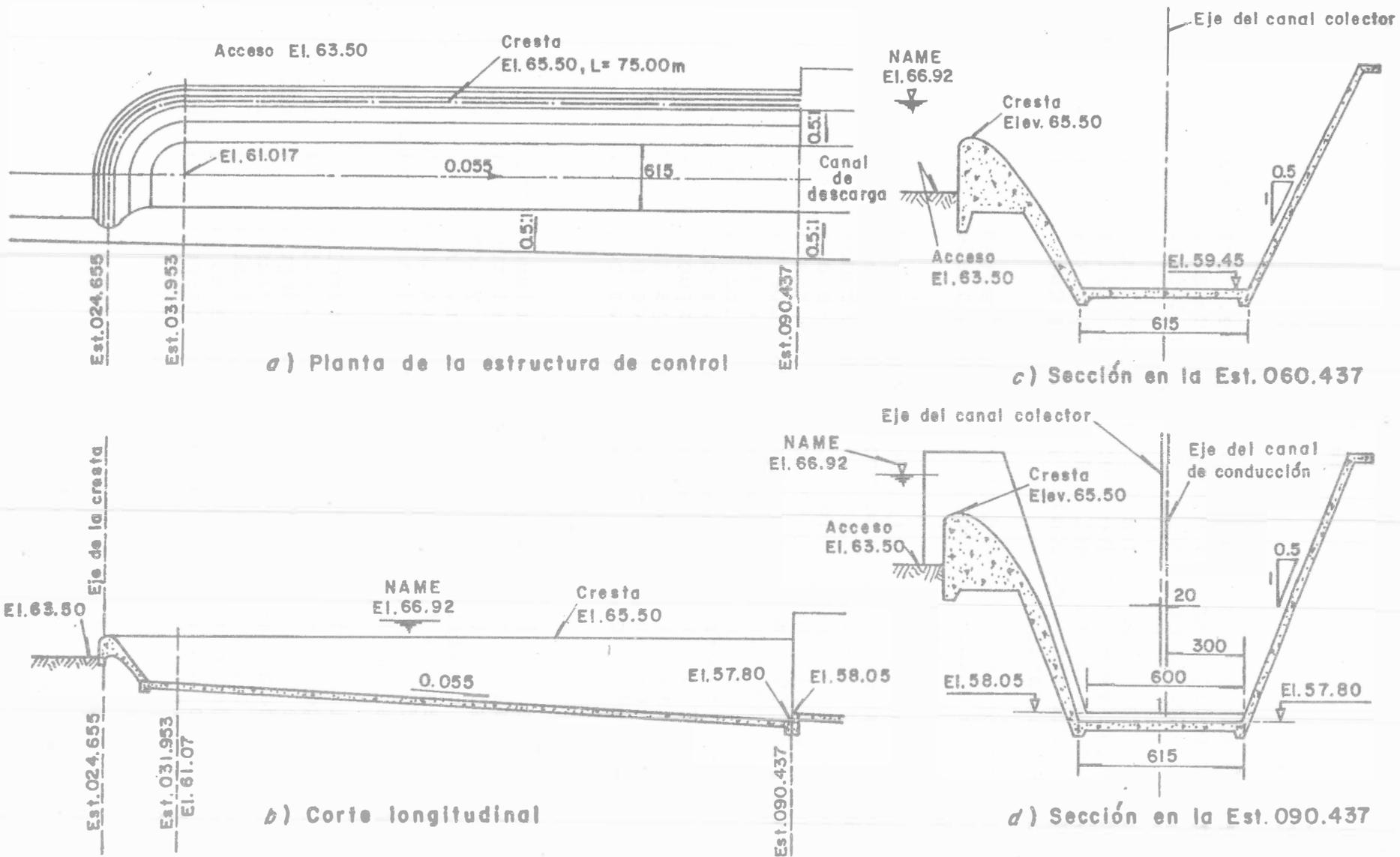
Figura 8.49 Geometría del vertedor de canal lateral del ejemplo 8.5s
