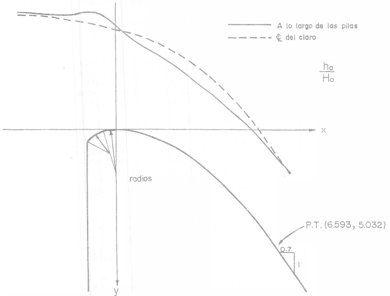
Fig. 8.28 Perfil del cimacio y de la superficie libre del agua en el vertedor del ejemplo 8.1
