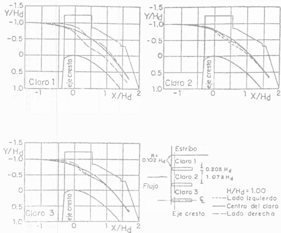
Fig. 8.22. Perfiles de agua sobre el cimacio tipo WES, con pilas y estribos, mostrando el efecto entre claros contiguos para  $H/H_d=1.00$  (ref. 71)
