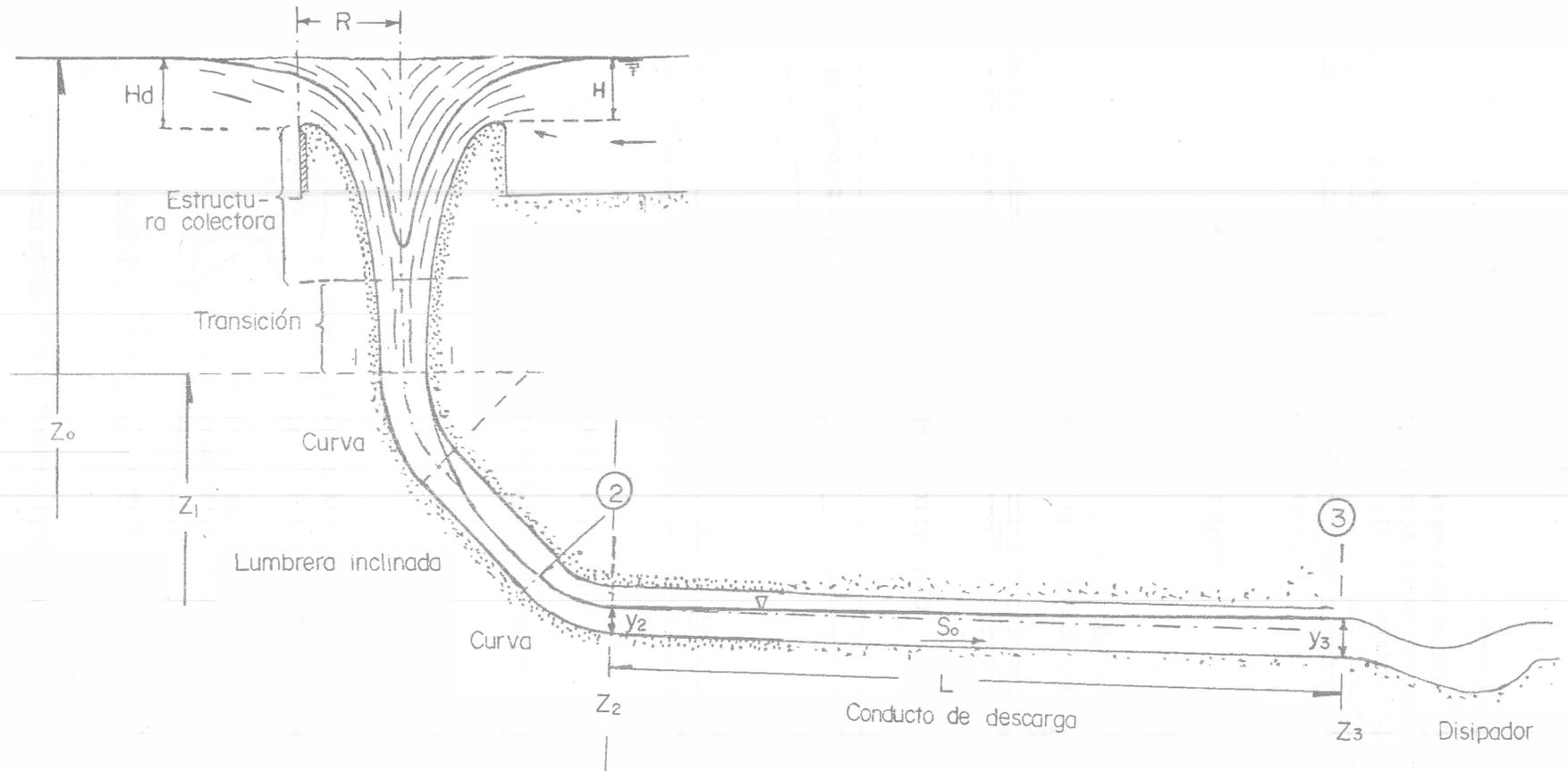
Fig. 8.52.- Componentes de un vertedor de embudo.
