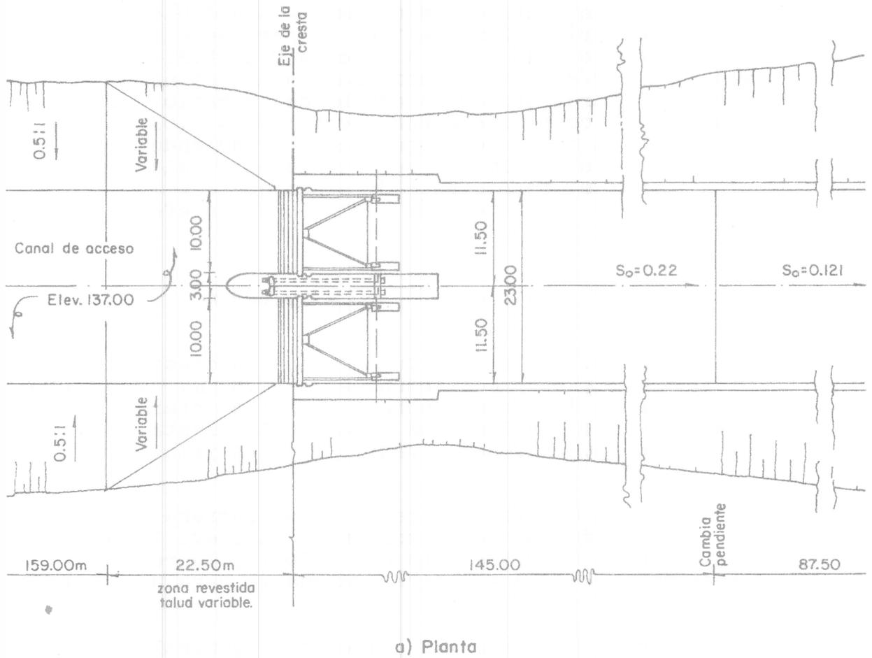
Fig. 8.41 Dimensiones generales del vertedor del ejemplo 8.3
