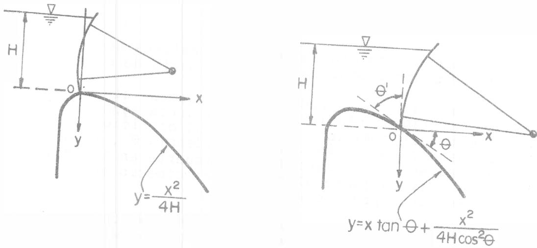
Fig. 8.34 Posiciones de la compuerta sobre un cimacio
