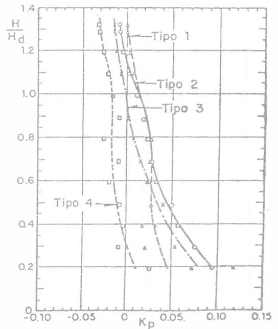
Fig. 8.10. Coeficiente de contracción por pilas de formas diferentes, con el tajamar coincidiendo con el plano vertical del paramento aguas arriba de un cimacio en perfil WES y velocidad de llegada despreciable (ref. 71)
