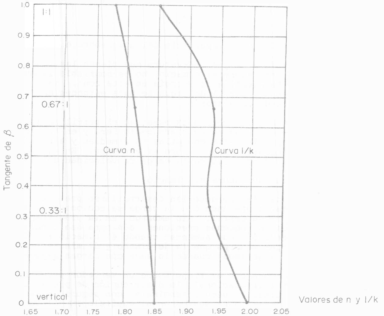
Fig. 8.18. Valores de  $n$  y  $1/k$  en la ec. (8.3 a) para el perfil de un cimacio tipo WES, velocidad de llegada despreciable y paramento aguas arriba con diferentes inclinaciones (ref. 71)  $P/H_d \geq 1$ .
