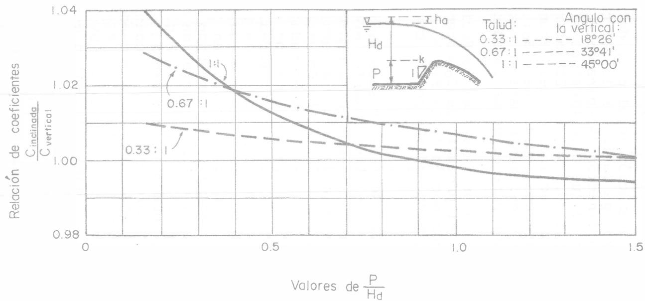
Fig. 8.4 Coeficiente de descarga en cimacios de paramento aguas arriba inclinado, vertiendo con la carga de diseño (ref. 21)
