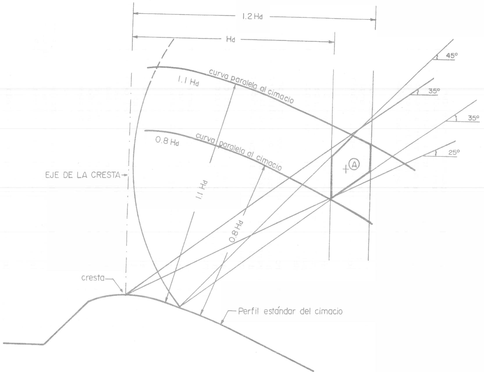
Fig. 8.40 Selección del radio de la compuerta y punto de apoyo en un vertedor controlado
