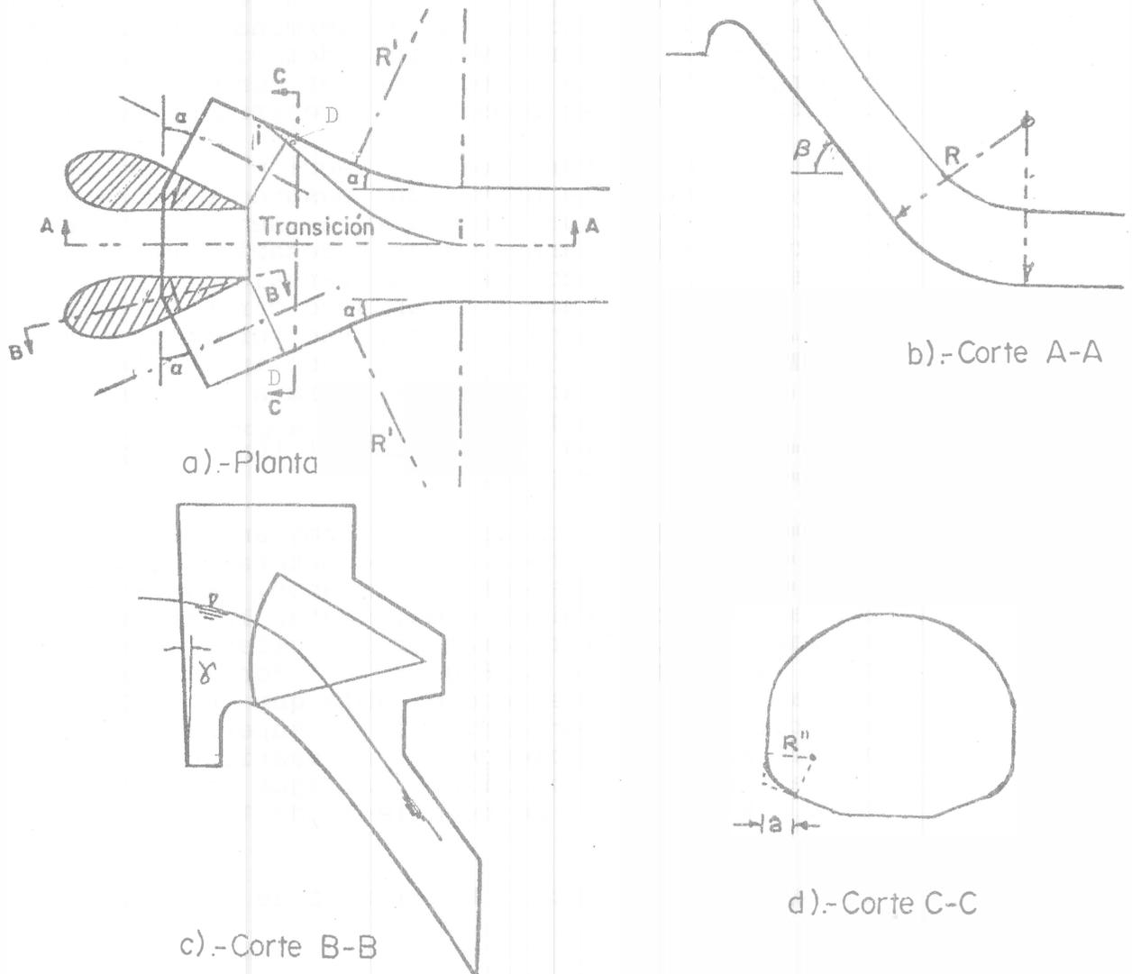
Fig. 8.51.- Geometría de la transición de un vertedor en túnel (Ref. 78)
