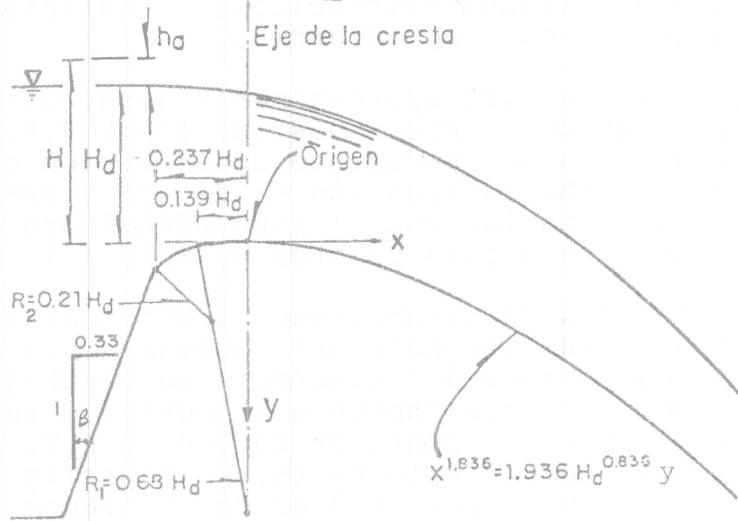
Fig. 8.16. Perfil de un cimacio tipo WES, con velocidad de llegada despreciable y paramento aguas arriba con talud 0.331:1 (ref. 71)  $P/H_d \geq 1$ .
