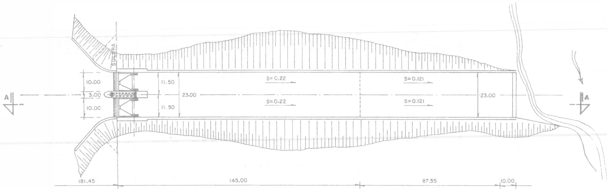
Figura 8.67a. Planta del vertedor del ejemplo 8.7.
