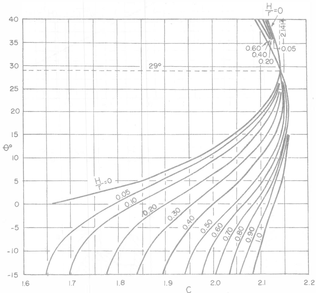
Fig. 8.32 Coeficiente de descarga  $C$  en compuertas de tambor (ref. 72).
