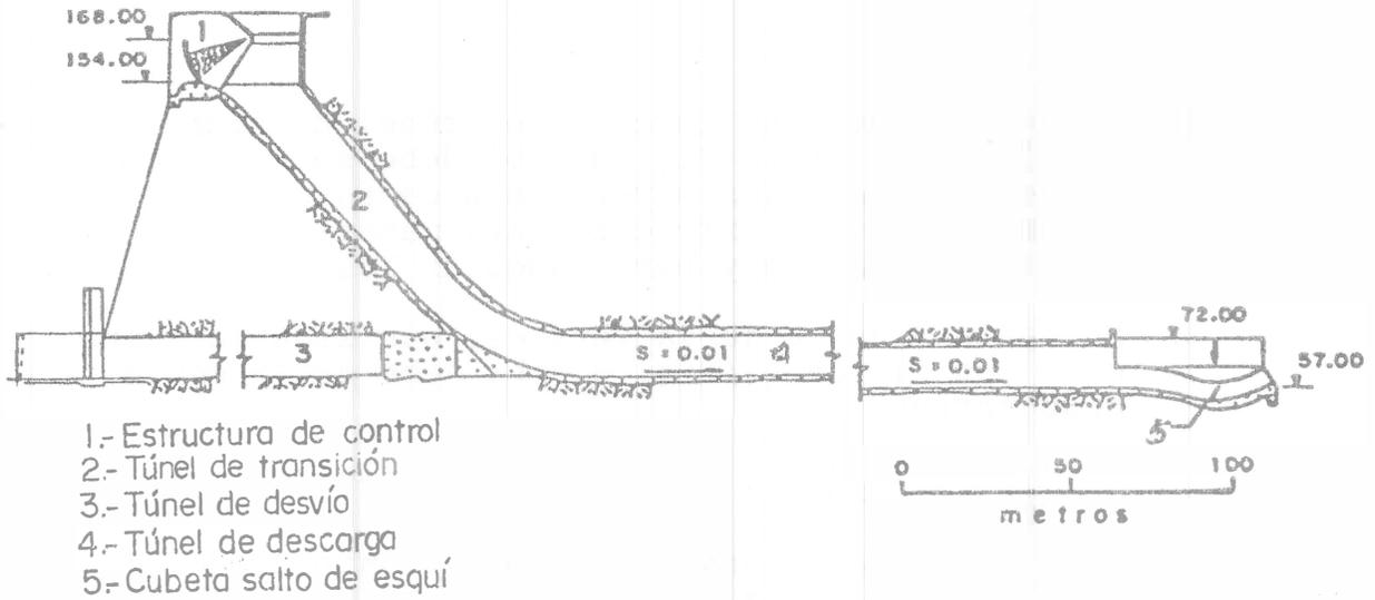
Fig. 8.50.- Vertedor en túnel presa El Infiernillo, Gro., Mich. (Ref. 78).
