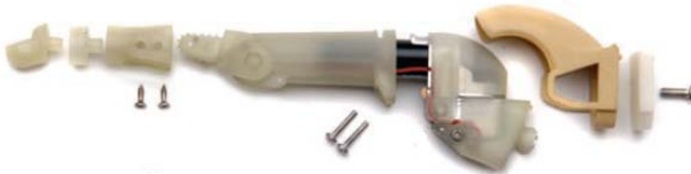
Figura 2.15 La ilustración muestra las partes que componen uno de los dedos de la prótesis [25]
