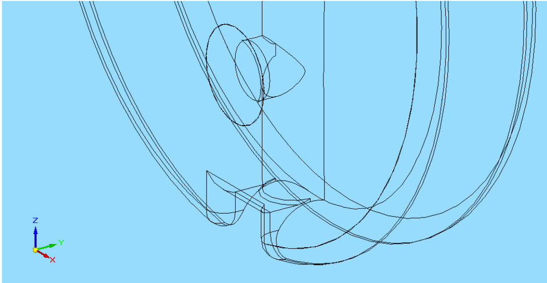
Figura 7.15 Barreno en la polea donde se anuda el tendón artificial
