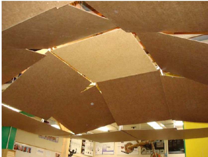
Figura 4.29. Domo formado al jalar el panel central del arreglo.
