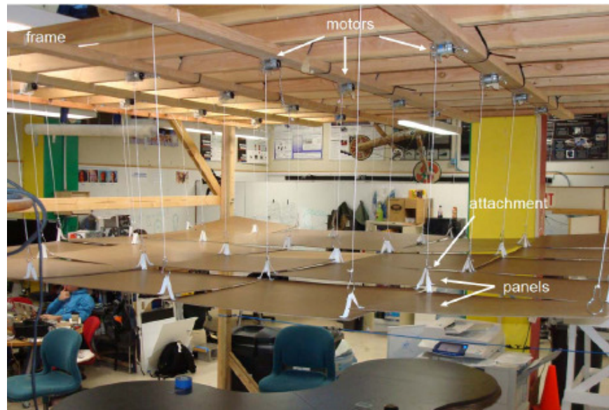
Figura 4.25. Disposición general del techo de reflectante.
