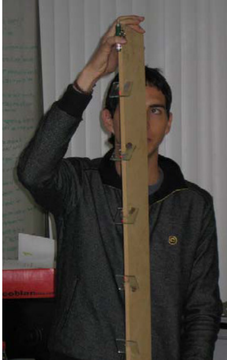
Figura 4.6 El laser es dividido en 6 a través de segmentos de vidrio en posición angulada.
