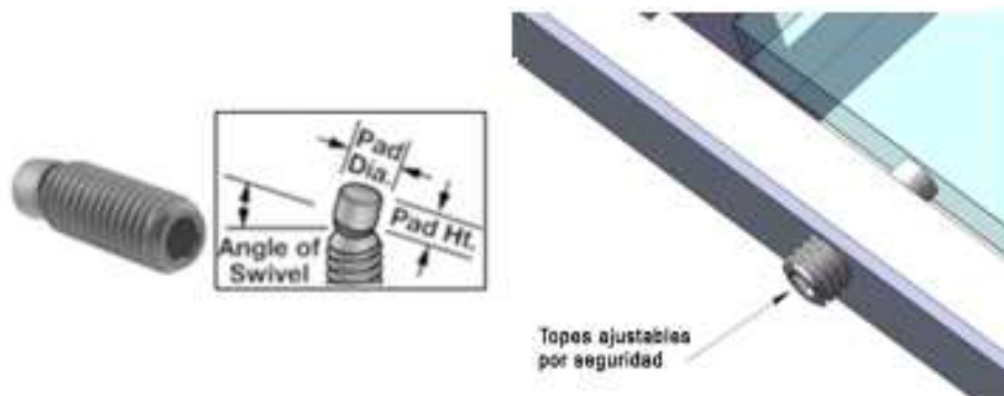
Figura 4.2: Topes ajustables montados en estructura principal
