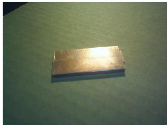
Figura 7.1.1. Placas conductoras de cobre que se colocan entre los dos imanes, y detalle de preparación para su conexión a las paredes de acrílico.
