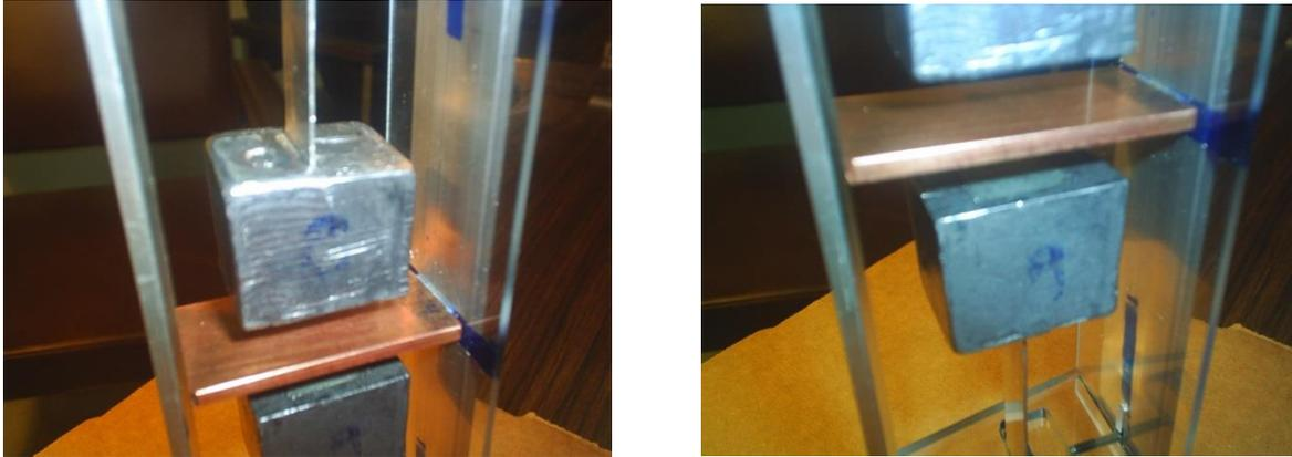
Figura 7.1.10. Placa central de cobre en posición horizontal y masas con imanes, a una separación de 0.728 cm entre caras de imanes de masas y cara de placa de cobre.
