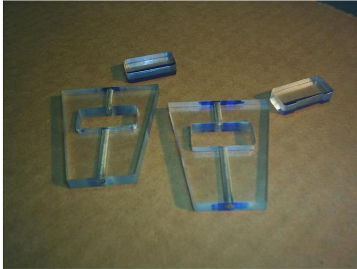
Figura 7.1.2. Soportes de placas de aluminio, con muescas en el centro, para introducir la placa de aluminio, con roscas de fijación para la muesca donde se introduce el tornillo de fijación de placa de aluminio al acrílico y a las paredes del marco de soporte.
