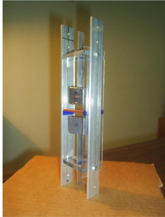
Figura 7.1.12. Vista general del modelo con 2 imanes y placa de cobre intermedia, con dos placas verticales de aluminio que forman parte del marco de rigidez.
