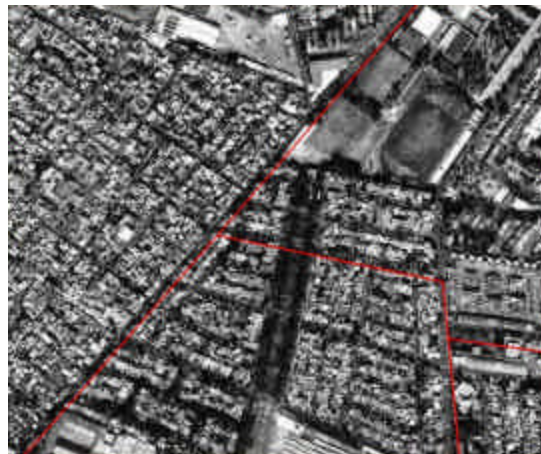
Figura 2.11 Ortofoto Digital Escala 1:20,000, en ITRF92 época 1988.0. y Capa Shape de delegación en ITRF92.
