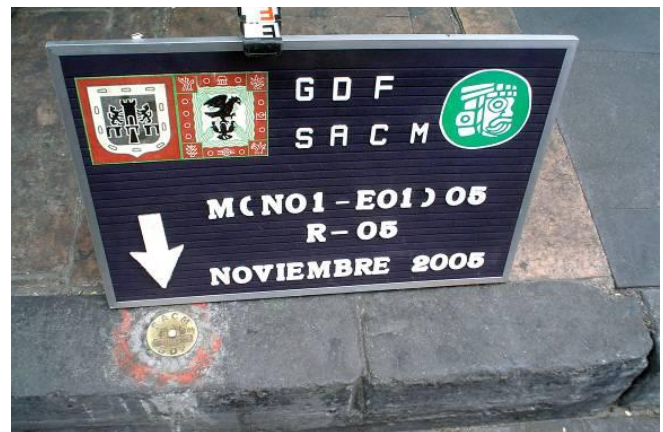
Fig. 12 Banco de Nivel Maestro en guarnición.
