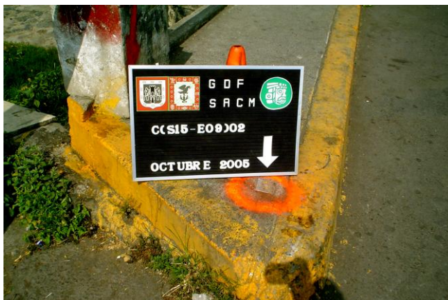
Fig. 13 Banco de nivel CNA, con placa cuadrada de aluminio, sobre guarnición.
