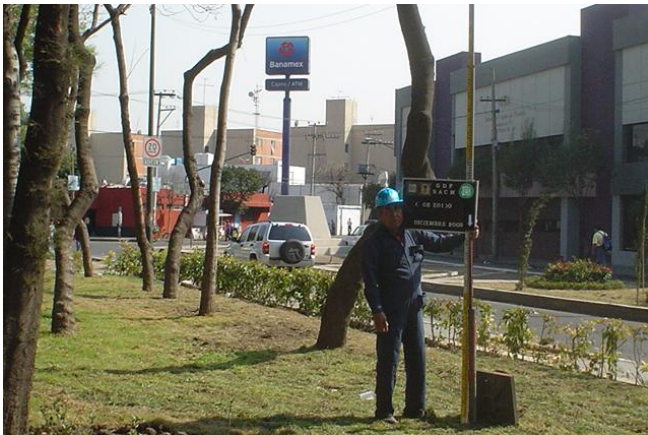
Fig. 11 Banco de Nivel Maestro enterrado, sobresale un tubo de 1.50 aprox.
