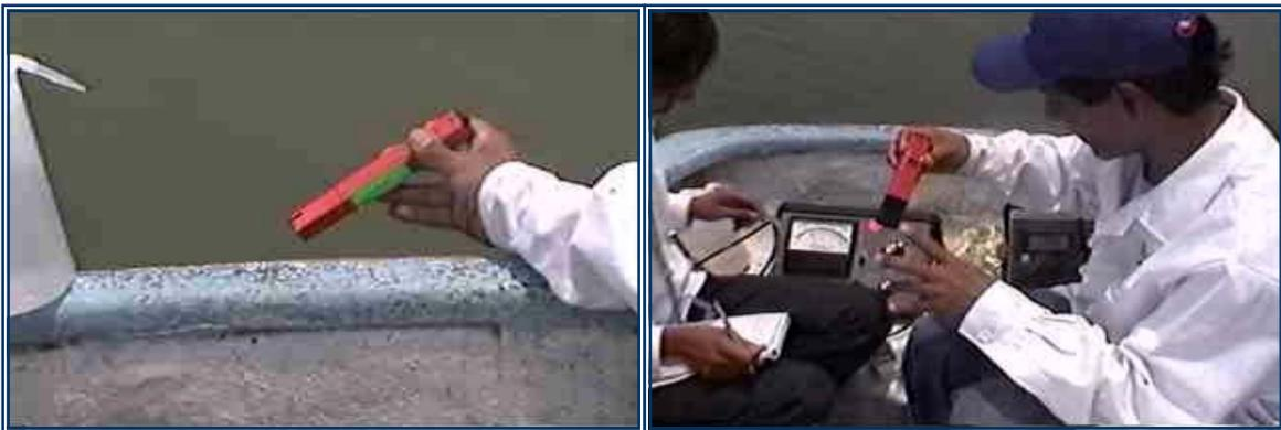
**Figura 3.7. Mediciones con el potenciómetro tipo pluma.**
