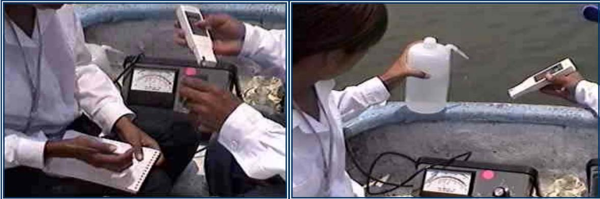
**Figura 3.6. Medidor de Sólidos Disueltos CORNING.**
