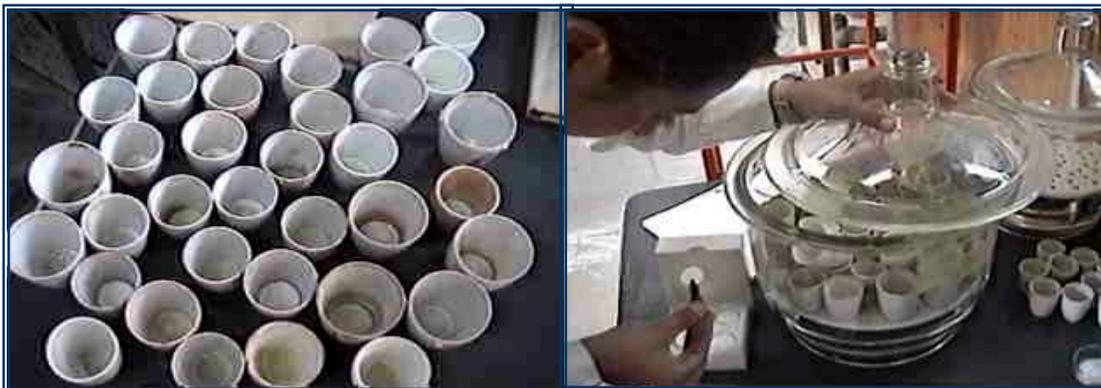
**Figura 3.12. Crisoles para determinar Sólidos Filtrables.**
