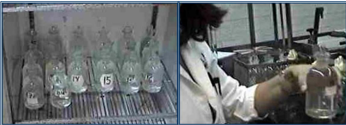
**Figura 3.9. Determinación de la Demanda Bioquímica de Oxígeno.**
