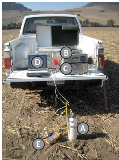
Figura 5.2: Vista general de toda la instrumentación instalada en la estación de trabajo número 12. (A) Cámara de acumulación con tubo de PVC insertada en el suelo; (B) analizador infrarrojo de dióxido de carbono; (C) unidad de control de flujo acoplada al analizador infrarrojo; (D) computadora portátil conectada al analizador infrarrojo; (E) Termómetro digital con termopares.
