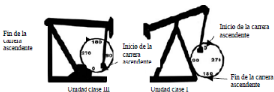
Figura 2 Inicio del movimiento ascendente [2].
