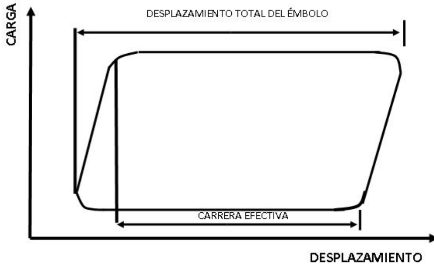
Figura 4.5 Gráfica de la bomba indicando tubería desanclada [2].
