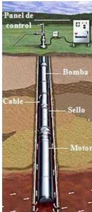
Fig. 1.3 Esquema representativo del sistema artificial de bombeo electrocentrífugo [31] .
