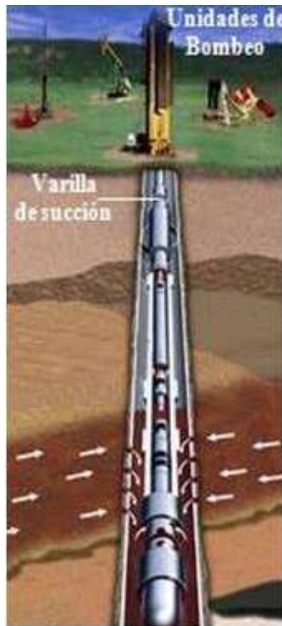
Fig. 1.2 Esquema representativo del sistema artificial de bombeo mecánico [31] .
