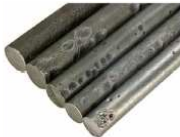
Figura 4.23 Corrosión influenciada microbiológicamente [20] .
