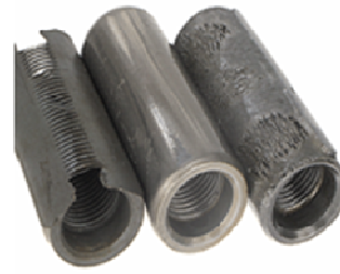
Figura 2.25 Falla del acoplador por abolladura [25] .
