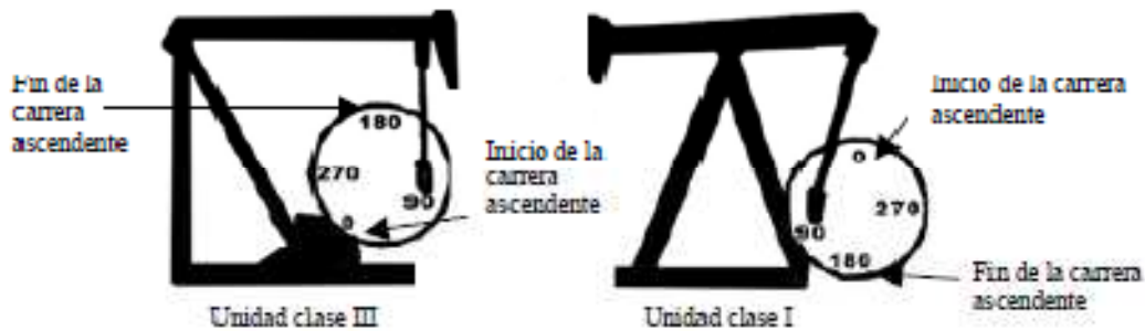
Figura 3 Movimiento de bombeo a los 90° [2].
