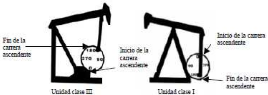
Figura 4 Movimiento de bombeo a los 180° [2].
