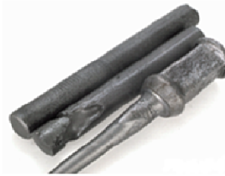
Figura 2.24 Falla por efecto de corrosión [25] .
