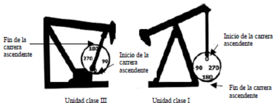
Figura 1 Posición de ambas unidades para iniciar la carrera ascendente [2].
