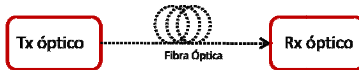
Figura 1.0 Diagrama de bloques básico de un sistema de comunicaciones óptico.
