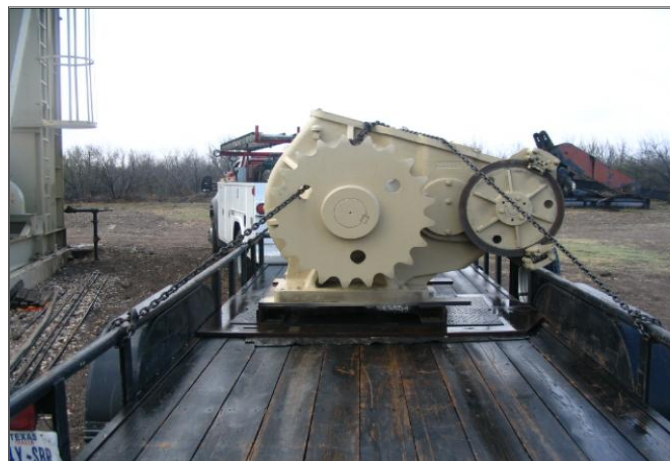
Figura 2.30. Reductor de velocidad
