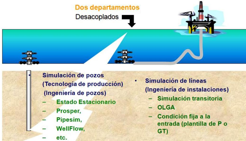
Figura 6.12. Comparación de OLGA con otros simuladores en simulación de pozos costa fuera<sup>4</sup>.
