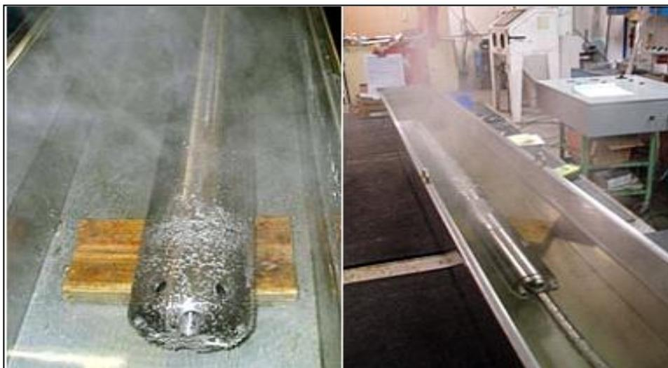
Figura 3.12. Sistema DHT siendo probado en superficie.<sup>8</sup>
