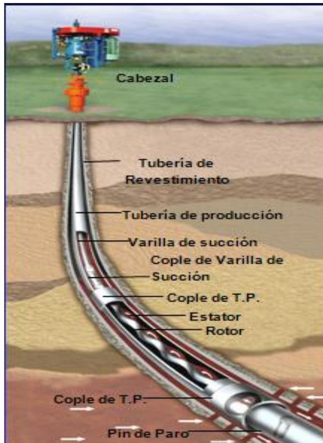
Figura 5.2. Diagrama del Bombeo en Cavidades Progresivas<sup>1</sup>.
