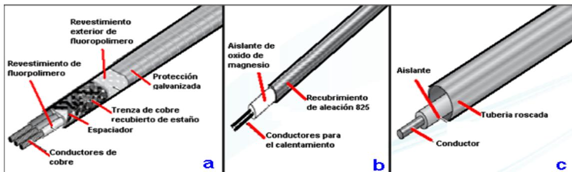
Figura 3.6. Componentes de cable, a) Cable DHSX, b) Cable MI, c) Cable STSi.<sup>4</sup>
