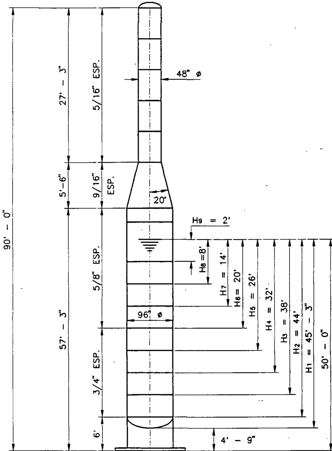
A continuación se calcularán las presiones hidrostáticas generadas por las diferentes alturas de las columnas de producto, considerando que una columna de agua de un pie de altura produce una presión de  $0.0305 \text{ Kg/cm}^2 = 0.4331 \text{ lb/Pulg}^2$ .
