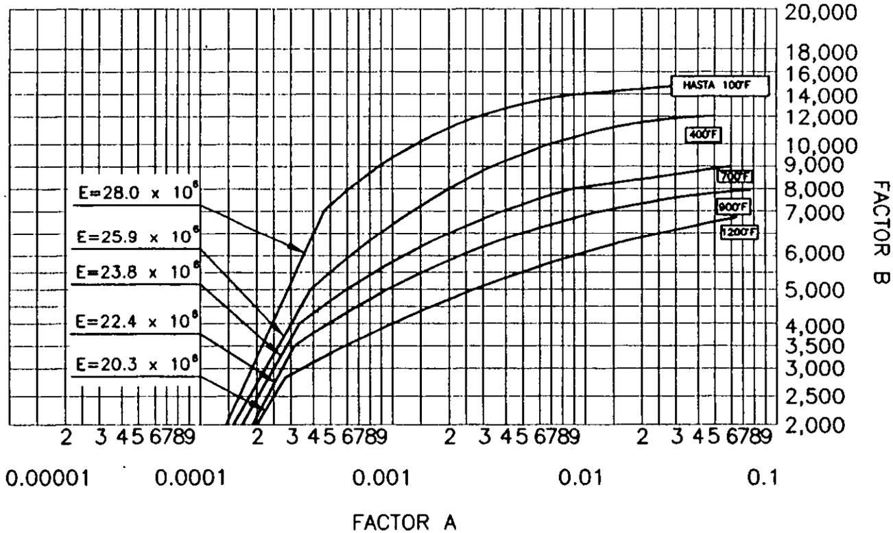
FIG. 5--UHA-28.1 (CODIGO ASME) GRAFICA PARA DETERMINAR ESPESORES DE ENVOLVENTE DE RECIPIENTES CILINDRICOS Y ESFERICOS SUJETOS A PRESION EXTERNA CUANDO SE CONSTRUYEN DE ACERO AUSTENITICO (18 Cr-8 Ni TIPO 304.)
