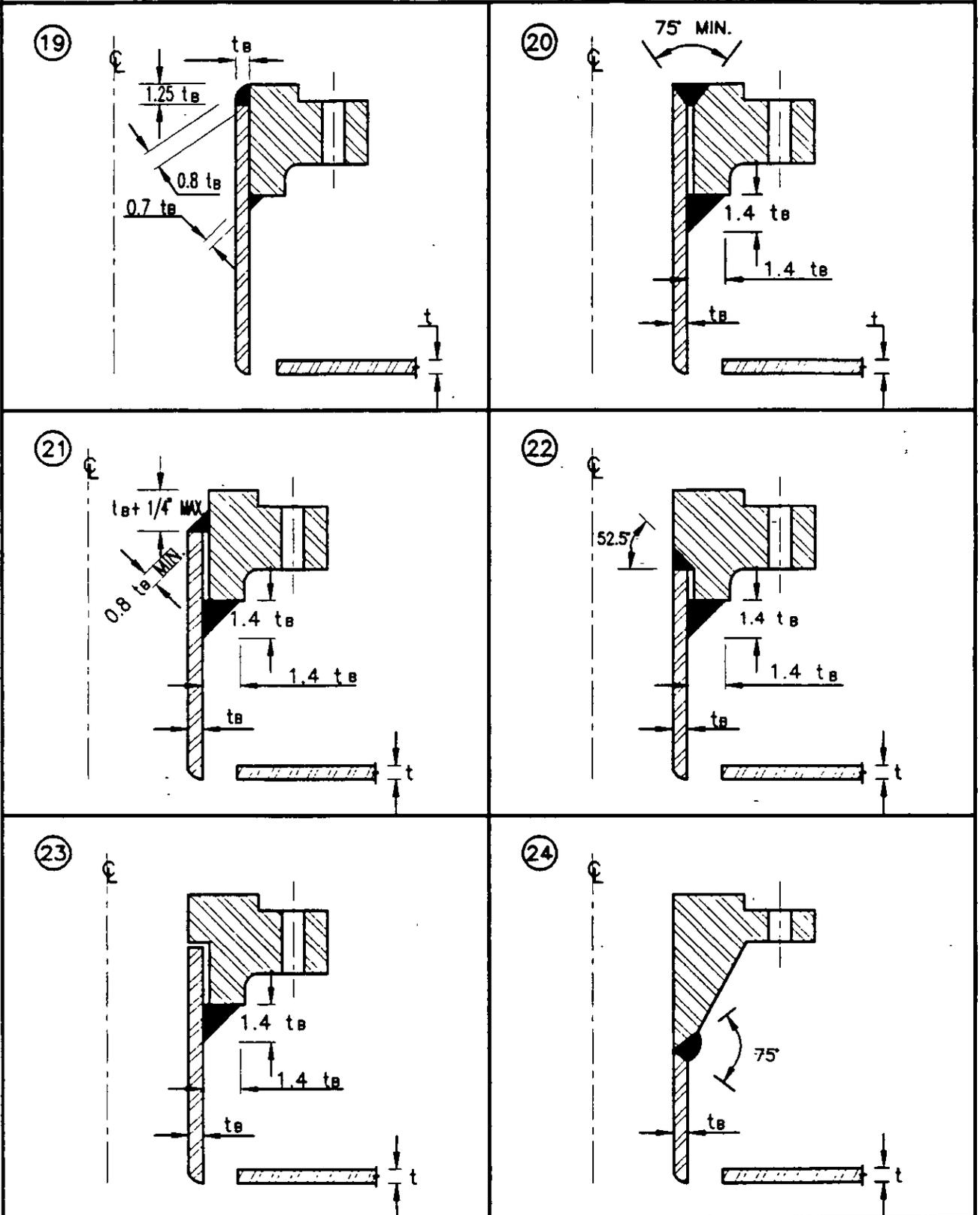
El material de aporte, de la soldadura, deberá ser compatible con el material base a soldar. Los electrodos más comúnmente utilizados para soldar recipientes a presión (acero al carbón, son el 6010 y el 7018.
