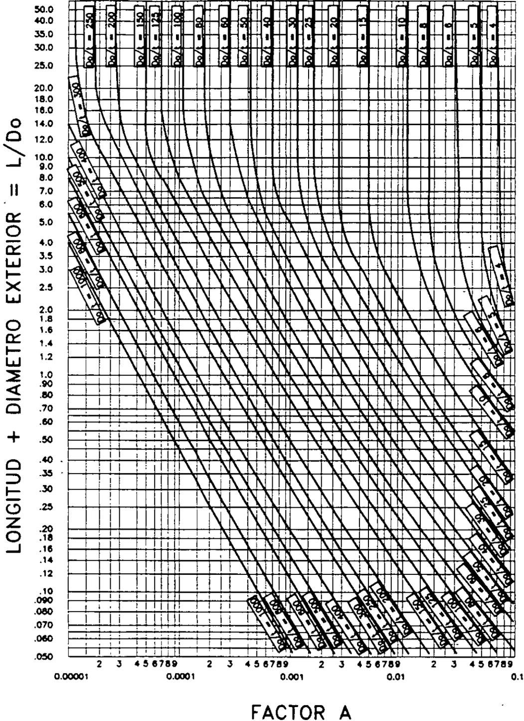
FIG.5-UGO-28.0 (CODIGO ASME) GRAFICA GEOMETRICA PARA RECIPIENTES
