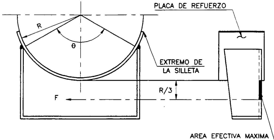
LA SECCION MAS BAJA DE LA SILLETA DEBERA RESISTIR LA FUERZA HORIZONTAL (F). LA SECCION TRANSVERSAL EFECTIVA DE LA SILLETA QUE RESISTIRA ESTA CARGA ESTARA A UN TERCIO DEL RADIO DEL RECIPIENTE (R).
