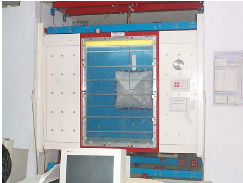
Fig. 7.5 Instalación del modelo en el túnel
