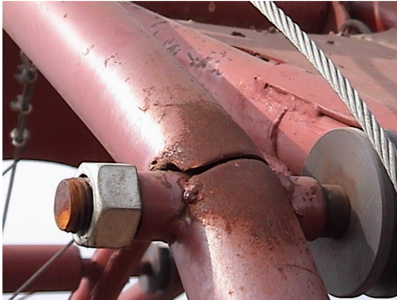
Fig. 6.40 Plastificación y ruptura en fibras a tensión
