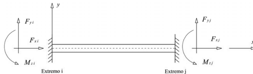
Fig. 4.2 Fuerzas en los extremos debido a un desplazamiento
