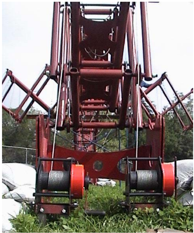
Fig. 6.31 Posición de los malacates en la base
