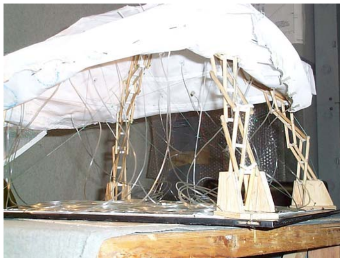
Fig. 7.4 Colocación de puertos en el manto
