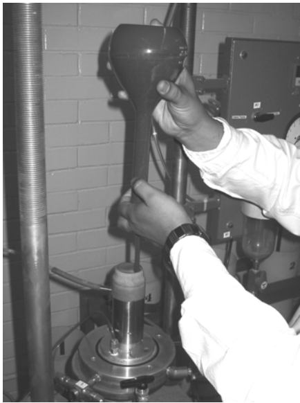
Figura 3.2.5 Montaje de una probeta
