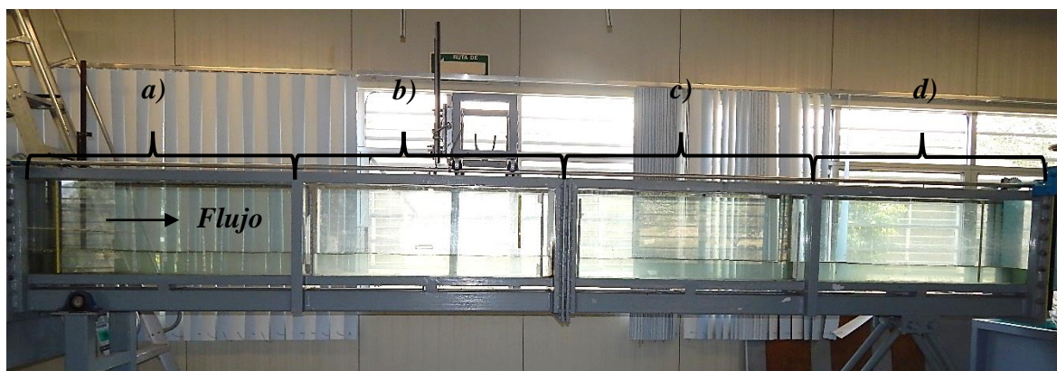
Figura 3.6 Estructuras tranquilizadoras del flujo
