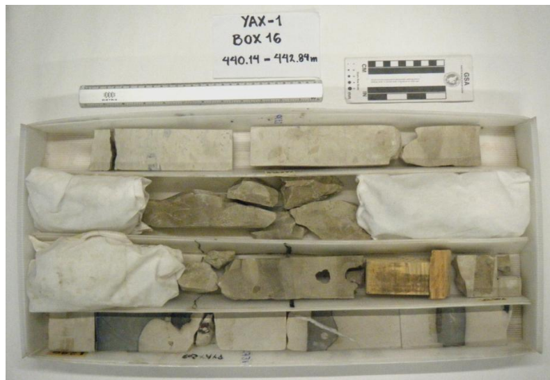
Fig. 7.12 Fotografía de la caja 16. Contacto litoestratigráfico (Horizonte HC), aproximadamente a 441 metros.
