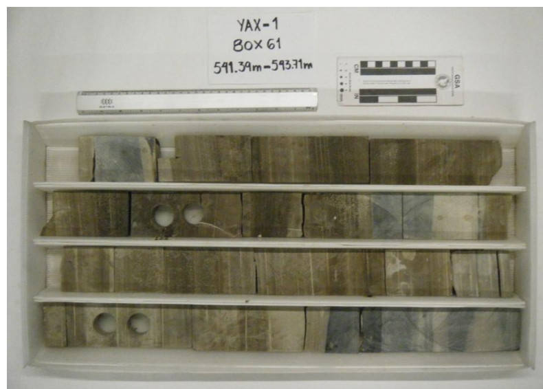
Fig. 7.13 Fotografía de la caja 61. Contacto litoestratigráfico (Horizonte H3), aproximadamente a 543 metros.
