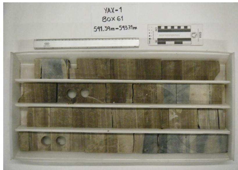
Fig. 7.19 Fotografía de la caja 61. Contacto litoestratigráfico (Horizonte H3), aproximadamente a 543 metros.
