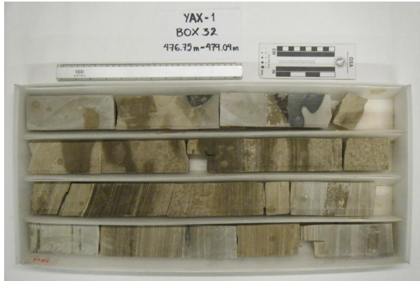
Fig. 7.18 Fotografía de la caja 32. Contacto litoestratigráfico (Horizonte H4), aproximadamente a 477 metros.
