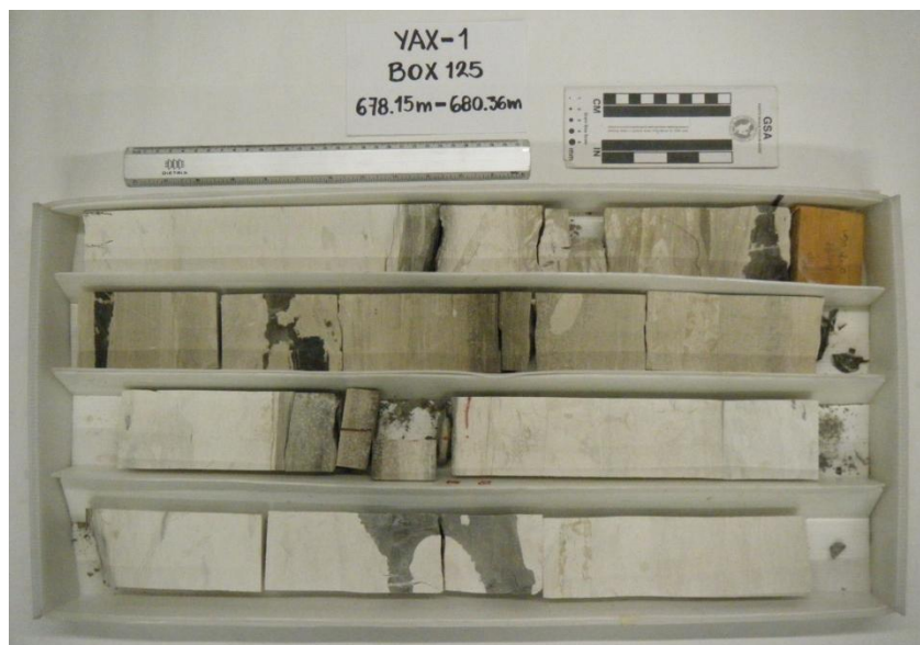
Fig. 7.23 Fotografía de la caja 125. Contacto litoestratigráfico (Horizonte H2), aproximadamente a 680 metros.
