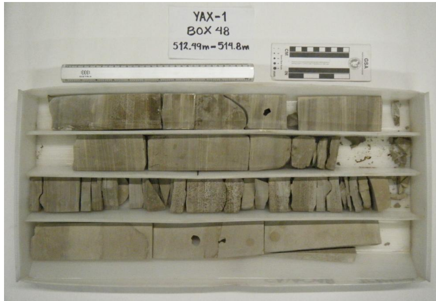
Fig. 7.21 Fotografía de la caja 48. Contacto litoestratigráfico (Horizonte H4), aproximadamente a 514 metros.
