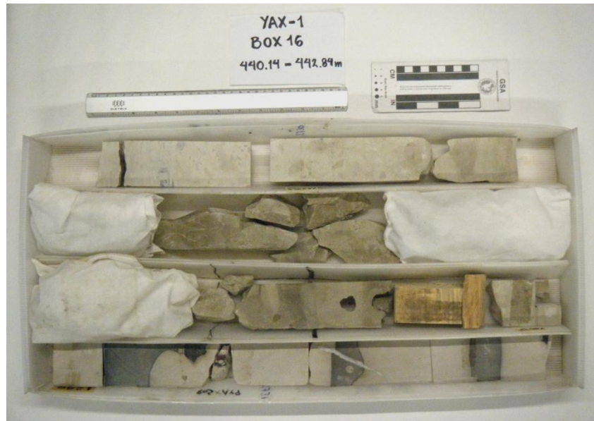
Fig. 7.7 Fotografía de la caja 16. Contacto litoestratigráfico (Horizonte H5), aproximadamente a 441 metros.
