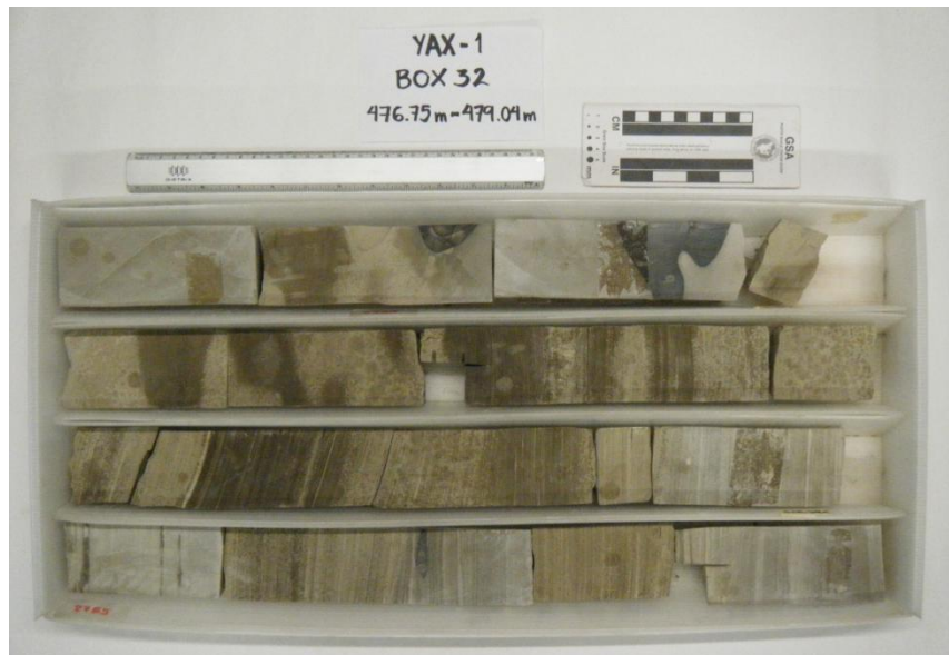
Fig. 7.10 Fotografía de la caja 32. Contacto litoestratigráfico (Horizonte H4), aproximadamente a 477 metros.
