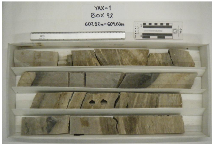
Fig. 7.22 Fotografía de la caja 92. Contacto litoestratigráfico (Horizonte H3), aproximadamente a 609 metros.
