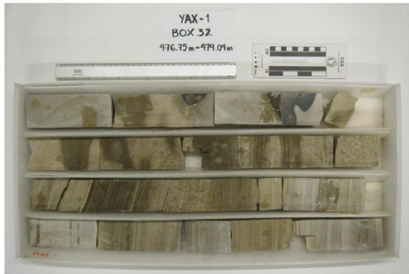
Fig. 7.14 Fotografía de la caja 32. Contacto litoestratigráfico (Horizonte H4), aproximadamente a 477 metros.
