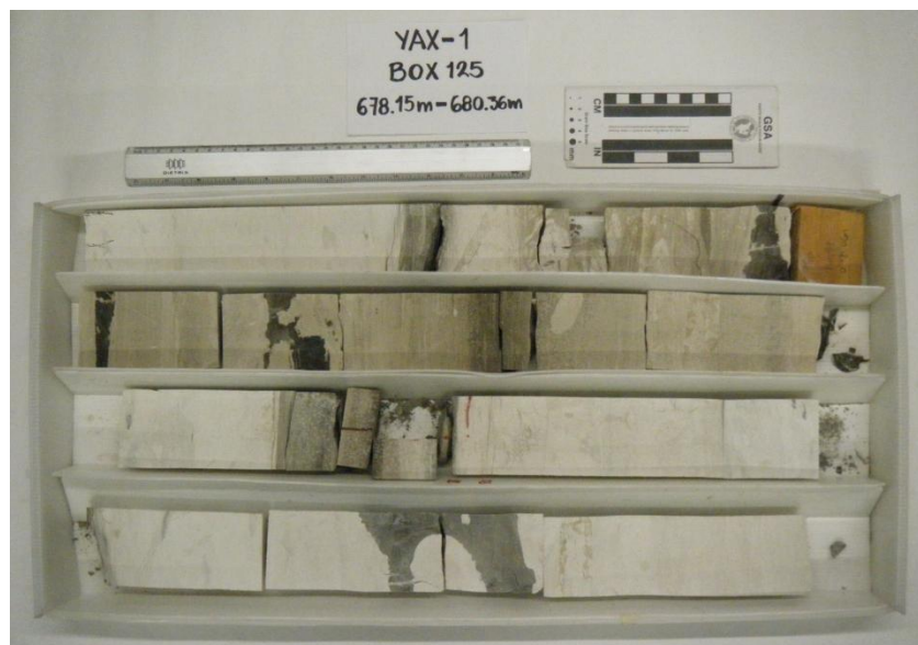
Fig. 7.15 Fotografía de la caja 125. Contacto litoestratigráfico (Horizonte H2), aproximadamente a 680 metros.
