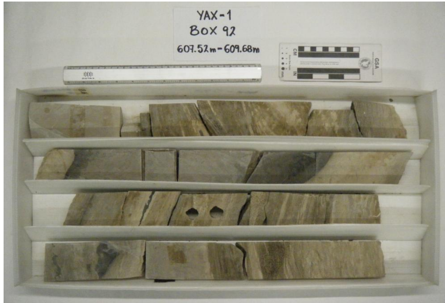
Fig. 7.9 Fotografía de la caja 92. Contacto litoestratigráfico (Horizonte HA), aproximadamente a 609 metros.
