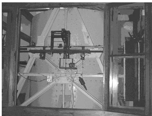
Figura II.1. Sismógrafo horizontal Wiechert de 1700 kg, 1910 (Fuente: http://www.ssn.unam.mx/website/html/SSN/IMG/Instrumentos/est-mecanica1.jpg )
