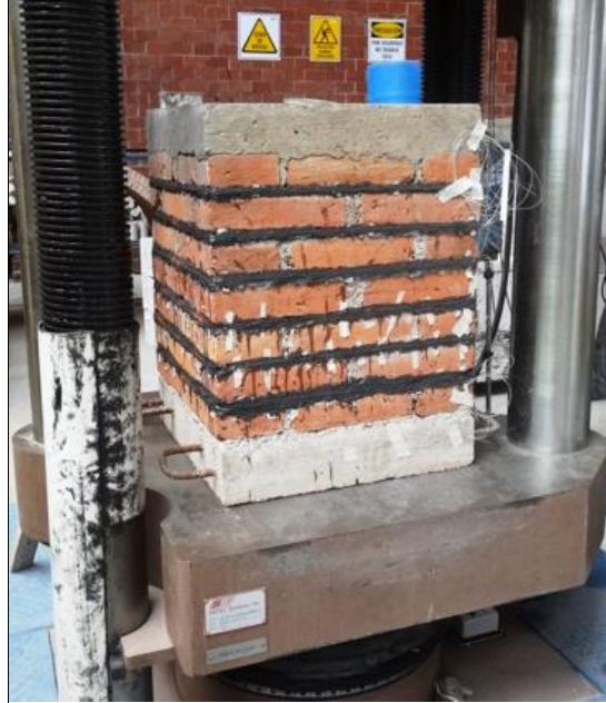
Figura 4.3 Pila de tabique instalada en el marco de prueba de la máquina de carga
