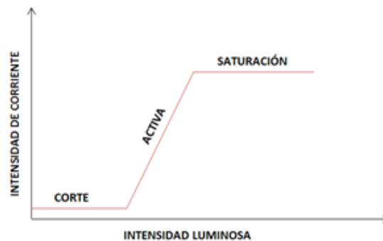
Figura 3.24 Grafica del comportamiento de un fototransistor
