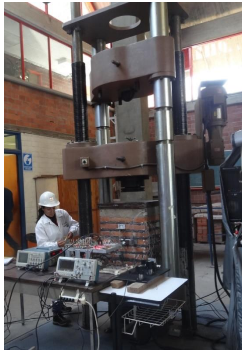
Figura 4.9 Máquina de carga universal con el espécimen de prueba y el interrogador opto-electrónico para la detección de daños estructurales
