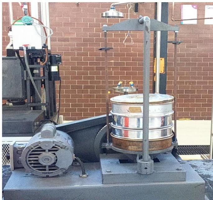
**Figura A.2.1.** Equipo granulómetrico del LIQ-FQ-UNAM
