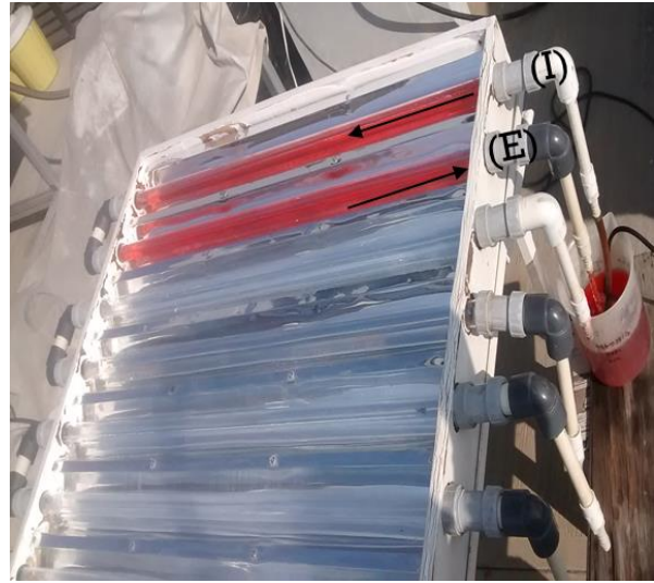
Figura 4-32. Fotografía del reactor solar utilizado a escala piloto, (I) influente; (E) efluente.
