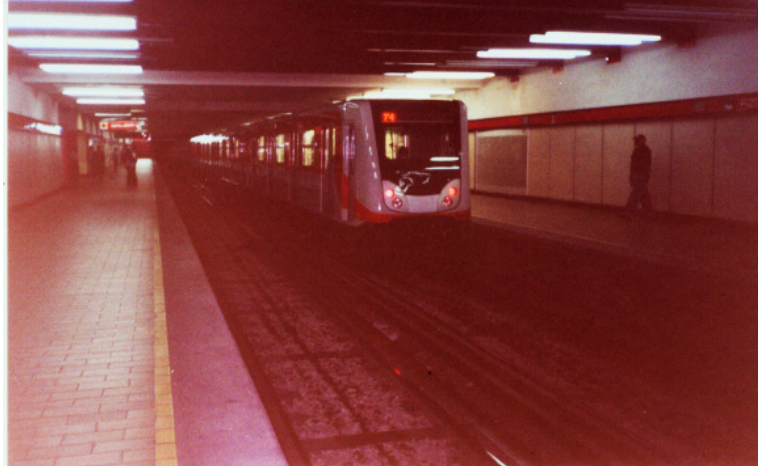
FIGURA 6.2 UNO DE LOS 45 TRENES MODELO NM 03 ADQUIRIDOS POR EL GDF PARA RENOVAR EL PARQUE VEHICULAR DE LA LÍNEA 2 DEL METRO.
