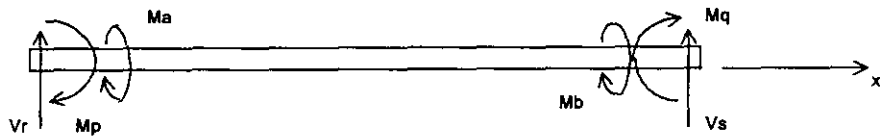
c) Elementos mecánicos (Barra sobre nudo)
