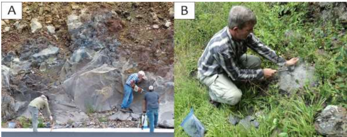
Figura 42. a) Recolección de muestras en campo. b) Remoción de costras de alteración con martillo geológico.
