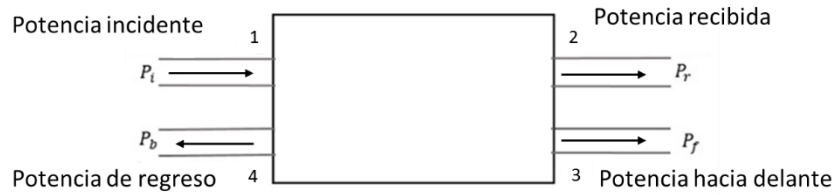
Figura 4.1 Modelo de un acoplador direccional genérico de 2 \times 2 .
