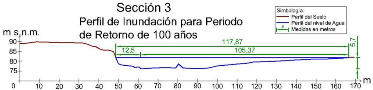
Ilustración 48.- Perfil de inundación para periodo de retorno de 100 años en la sección 3.
