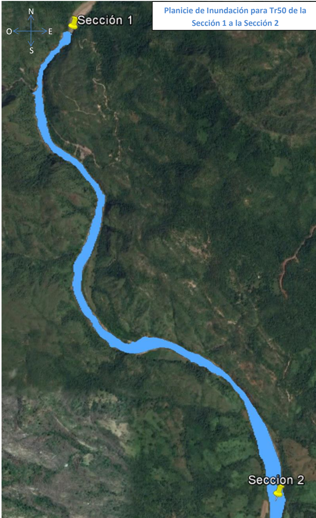
Ilustración 131.- Planicie de inundación para Tr50, sección 1 a sección 2.
