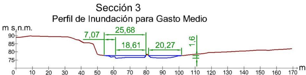
Ilustración 42.- Perfil de inundación para gasto medio en la sección 3.
