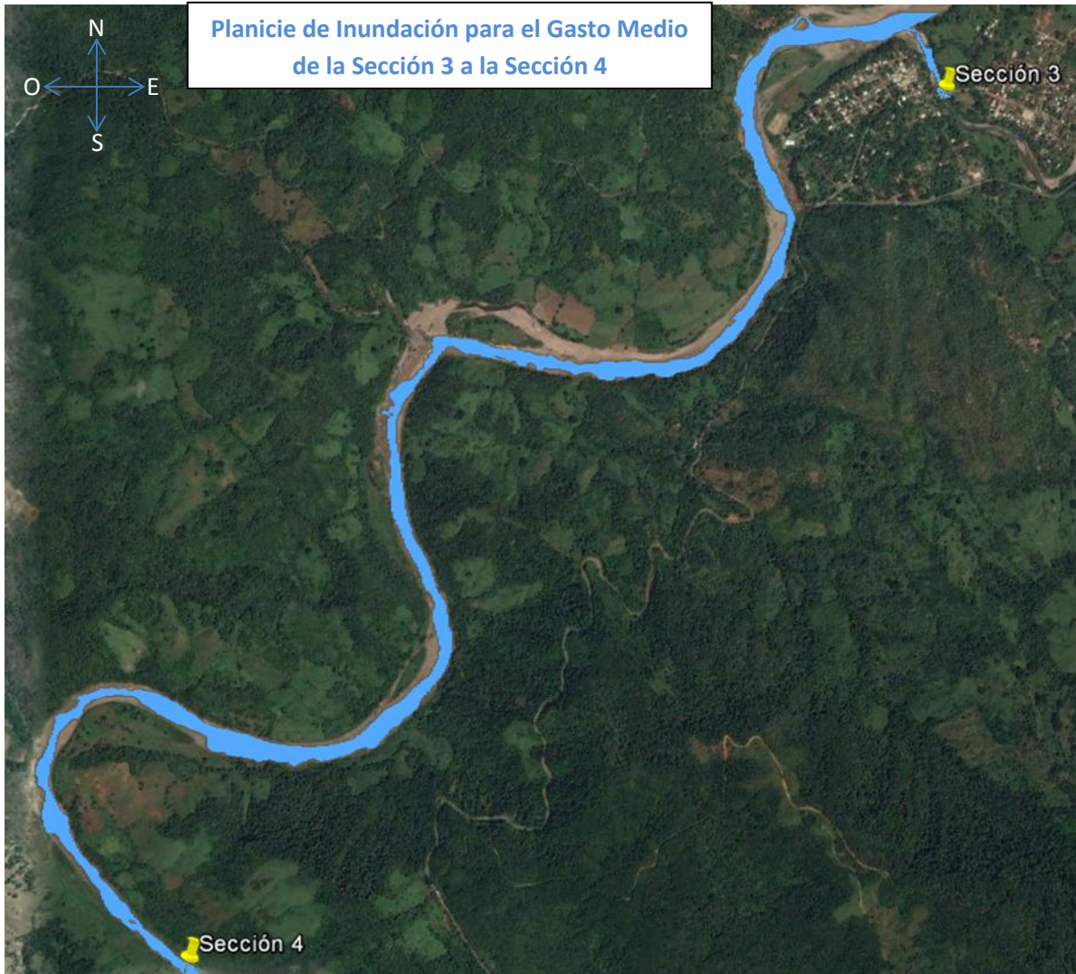
Ilustración 93.- Planicie de inundación para gasto medio, sección 3 a sección 4.
