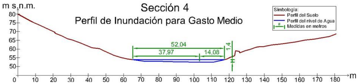
Ilustración 49.- Perfil de inundación para gasto medio en la sección 4.
