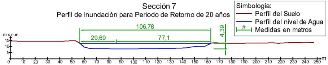
Ilustración 74.- Perfil de inundación para periodo de retorno de 20 años en la sección 7.
