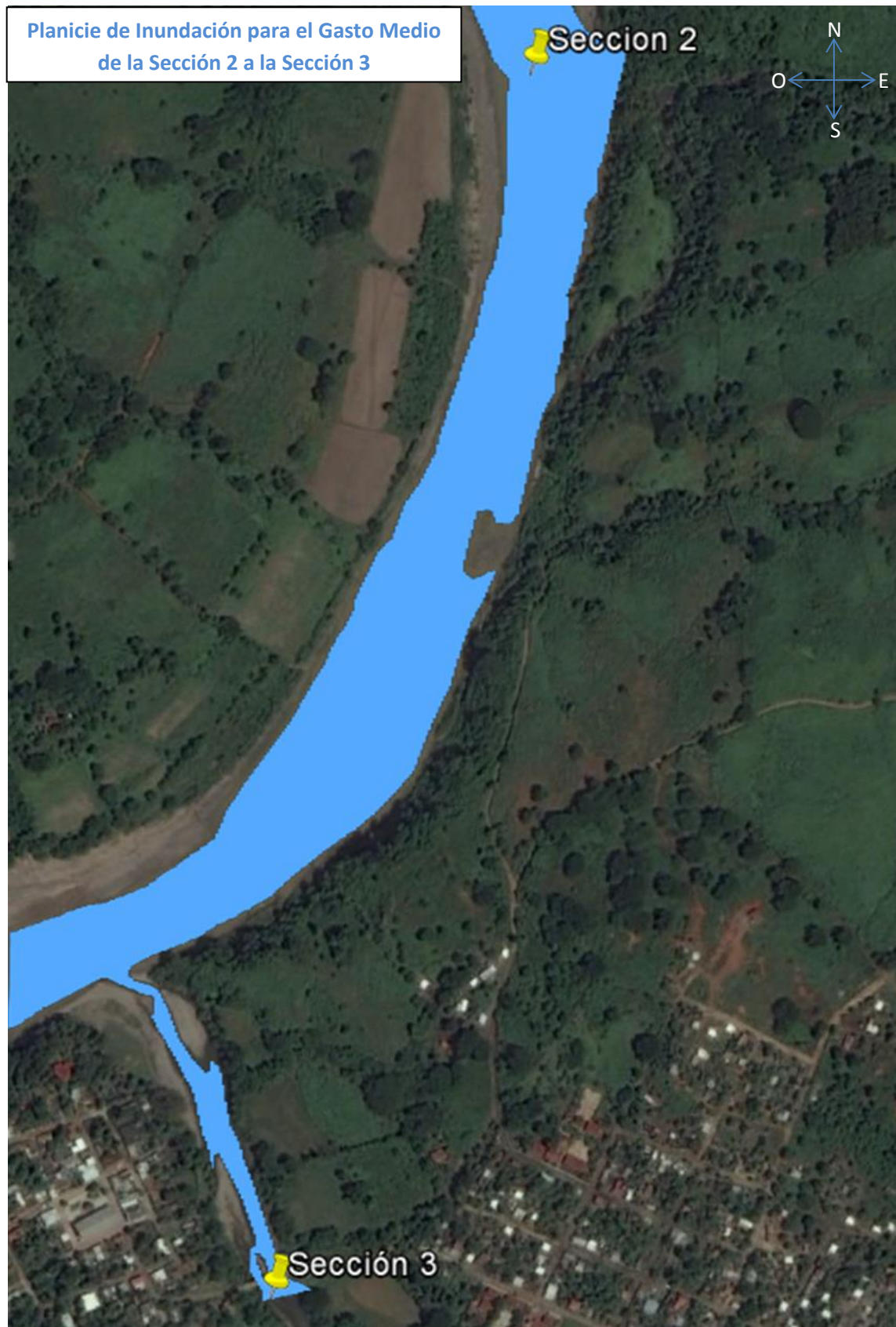
Ilustración 92.- Planicie de inundación para gasto medio, sección 2 a sección 3.
