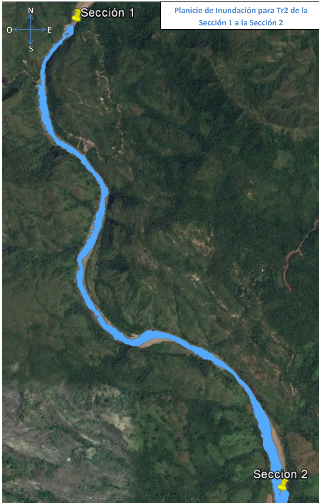
Ilustración 99.- Planicie de inundación para Tr2, sección 1 a sección 2.
