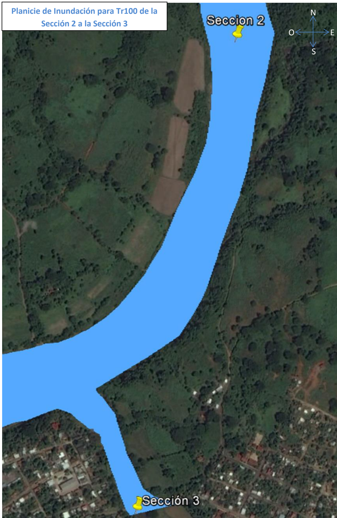
Ilustración 140.- Planicie de inundación para Tr100, sección 2 a sección 3.
