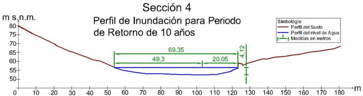
Ilustración 52.- Perfil de inundación para periodo de retorno de 10 años en la sección 4.
