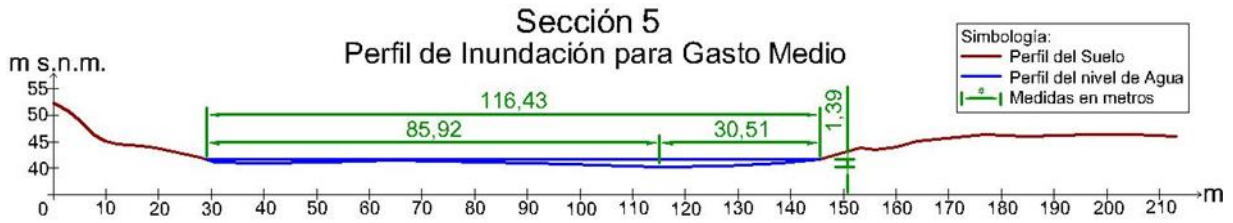
Ilustración 56.- Perfil de inundación para gasto medio en la sección 5.
