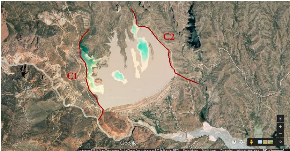
Figura 44. Posición de canales de desvío.
