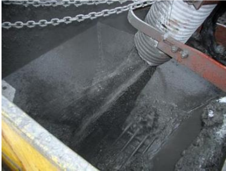
Figura 12. Jal como relleno de minas subterráneas (Tailings.Info, 2016).
