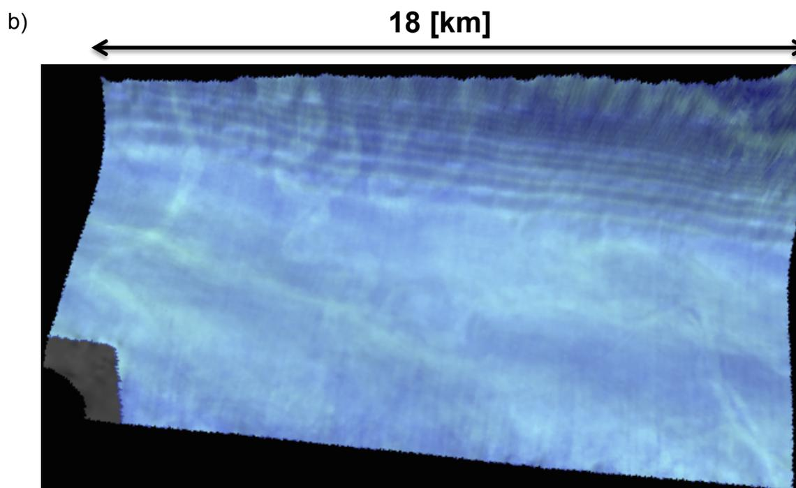
Figura 5.1 a) Superficie resultante de aplicar el atributo sísmico híbrido RL1 en la cual se pueden observar meandros y canales anastomosados. b) Es la superficie resultante de la aplicación del atributo RMS al cubo sísmico generado del atributo sísmico híbrido RL1. Los rasgos estratigráficos se presentan con mayor claridad en la figura 5.1 a).
