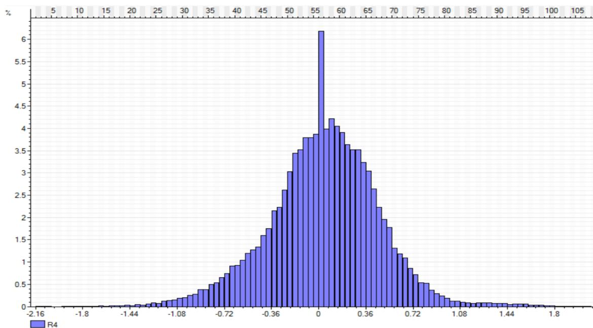
*Figura 5.17 Se muestra el histograma de frecuencias que corresponde con la diferencia de la primera derivada del atributo RMS con la primera derivada del atributo sísmico híbrido propuesto RL4. Estadísticamente, el atributo RL4 y el RMS son similares.*
