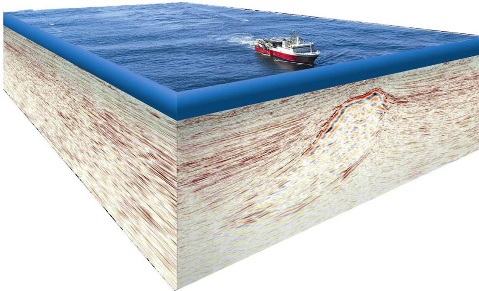
*Figura A.3 El resultado de un estudio sísmico es un cubo sísmico conformado por un volumen de datos que contiene toda la información del subsuelo (Tomada de <https://www.noia.org/policy-issues/seismic/>).*
