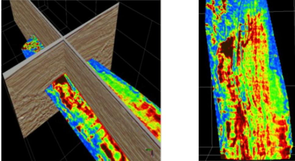
*Figura 3.3 Aplicación de atributo amplitud instantánea. Donde se intersectan los planos superpuestos se puede observar una zona con mayor intensidad en la reflexión (Tomado de <http://equipo2saep2016-1.weebly.com/blog/analisis-de-atributos>, 2015).*
