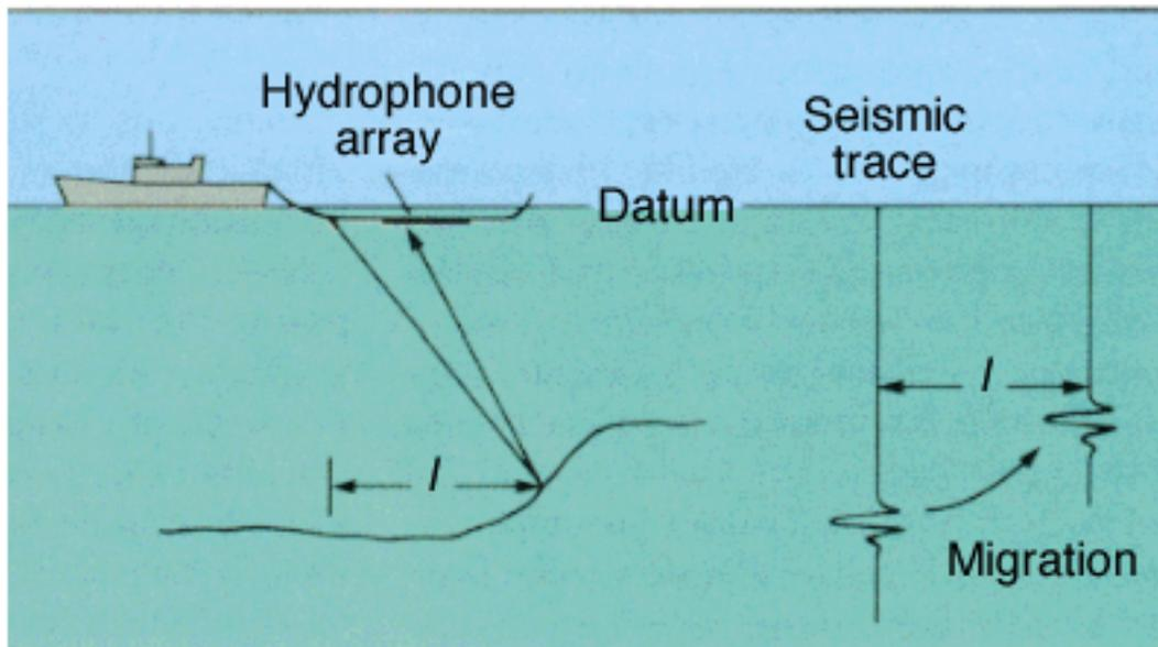
*Figura A.5 La migración es una parte importante en el procesamiento de datos sísmicos, ajusta la localización de los eventos en las trazas sísmicas para compensar el efecto de los reflectores inclinados (Tomada de [www.glossary.oilfield.slb.com/Terms/m/migration.aspx](http://www.glossary.oilfield.slb.com/Terms/m/migration.aspx)).*
