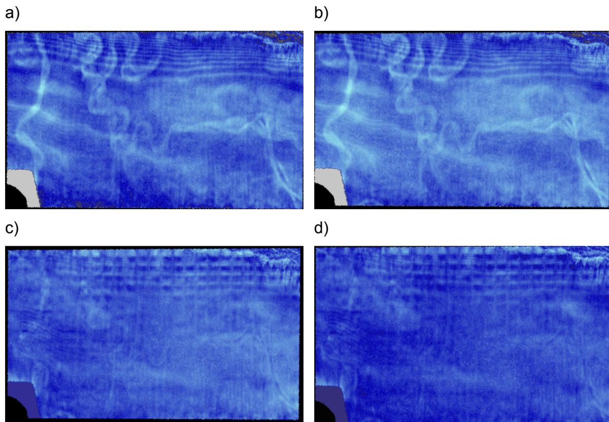
*Figura 5.22 a) Superficie tras aplicar el atributo sísmico híbrido RL7 propuesto que involucra a la desviación estándar del RMS. b) Resultado de aplicar el atributo sísmico RMS sobre la superficie donde se encuentran los rasgos estratigráficos. c) Resultado tras aplicar el atributo Envelope en la superficie objetivo. d) Superficie obtenida tras aplicar el atributo Sweetness a la superficie que cuenta con los rasgos estratigráficos.*
