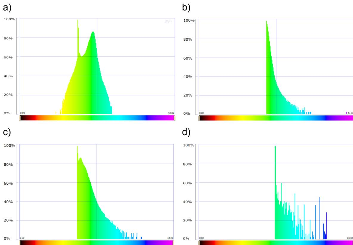
*Figura 5.21 a) Para el cubo original se tiene una banda de frecuencias de 10 a 25 [Hz] siendo la frecuencia dominante 16 [Hz]. b) Para el atributo RL4, la banda de frecuencias va de 18 a 31 [Hz] siendo la frecuencia dominante de 19 [Hz]. c) Para el atributo RL7, la banda de frecuencias es de 16 a 34 [Hz] y la frecuencia dominante es de 16 [Hz]. d) Para el atributo RL14, la banda de frecuencias es de 21 a 35 [Hz] y la frecuencia dominante es de 21 [Hz].*
