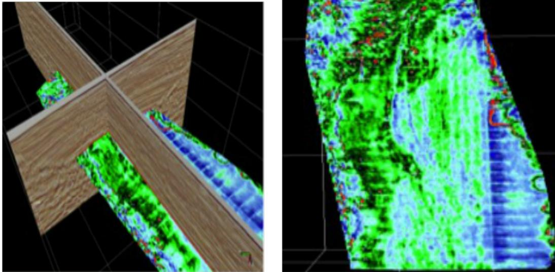
*Figura 3.4 Atributo de frecuencia instantánea. En la parte donde se intersectan los planos superpuestos se puede distinguir la atenuación de altas frecuencias (Tomado de <http://equipo2saep2016-1.weebly.com/blog/analisis-de-atributos>, 2015).*
