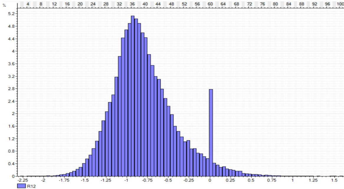
*Figura 5.19 Histograma de frecuencias correspondiente a la diferencia de la primera derivada del atributo RMS con la primera derivada del atributo sísmico híbrido propuesto RL12. De los atributos exitosos, es el que presenta la diferencia más amplia entre las primeras derivadas.*
