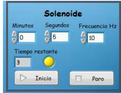
Figura 18. Control válvula solenoide
