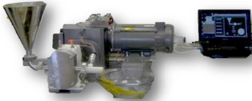
Figura 5. Reómetro de orificio CCADET-UNAM
