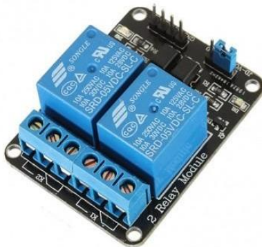
Figura 16. Módulo de relevadores
