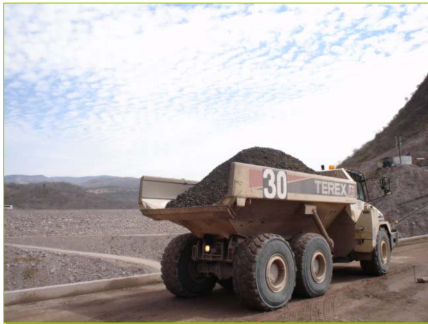
Fotografía III.1 CAMION ARTICULADO TEREX TA 30, COLOCANDOSE EN LA FRANJA DE MATERIAL 2.
