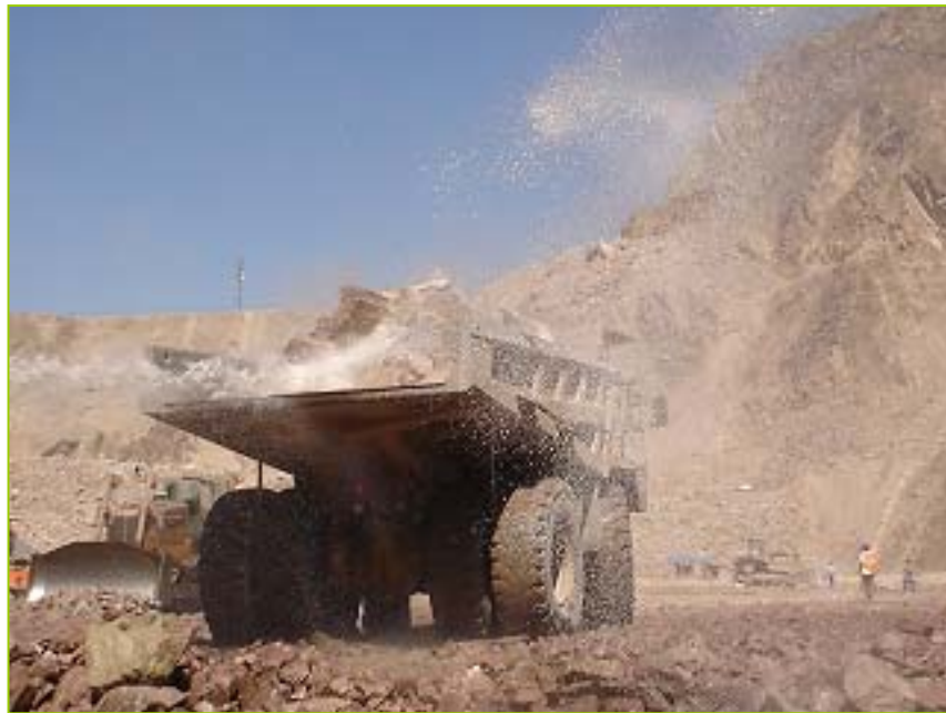
Fotografía III.6. Humectación del material antes de ser depositado.
