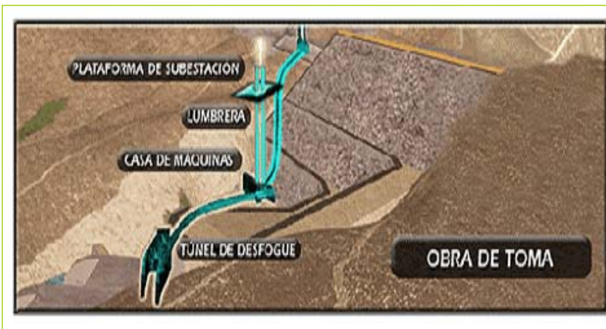
Fig I.6. COMPONENTES DE LA OBRA DE GENERACION.
