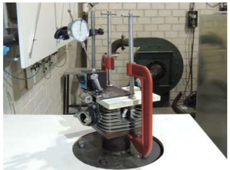
Fig. 4.4 Cabeza del motor + Acoplador
