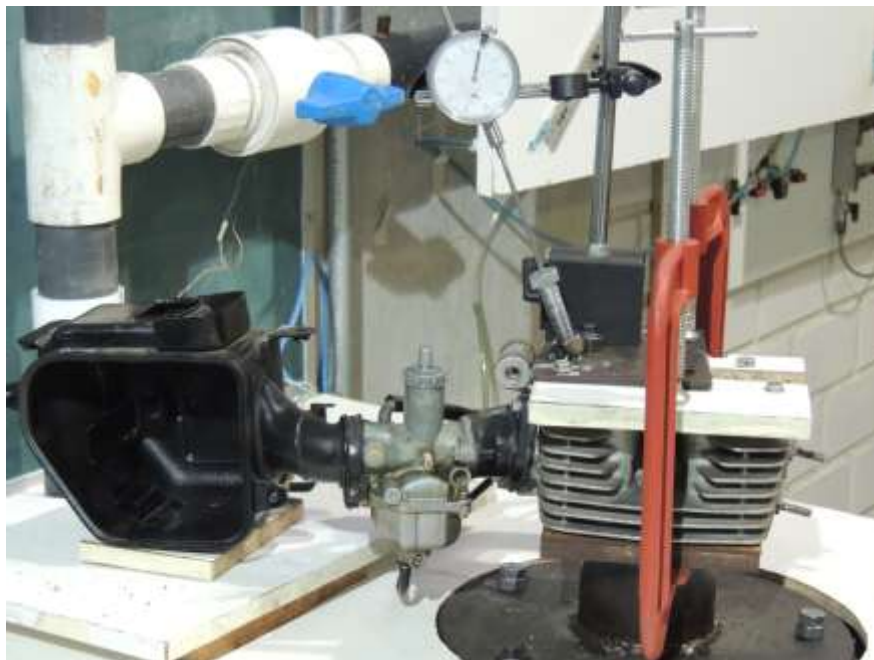
Fig. 4.6 Cabeza del motor + Acoplador + Carburador + Base del filtro
