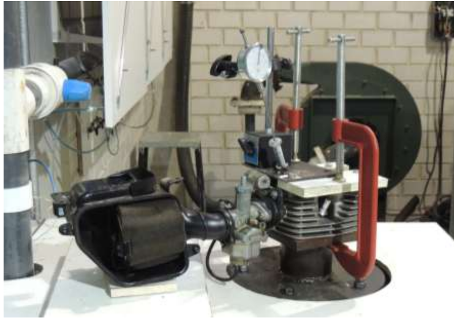
Fig. 4.7 Cabeza del motor + Acoplador + Carburador + Base del filtro + Filtro
