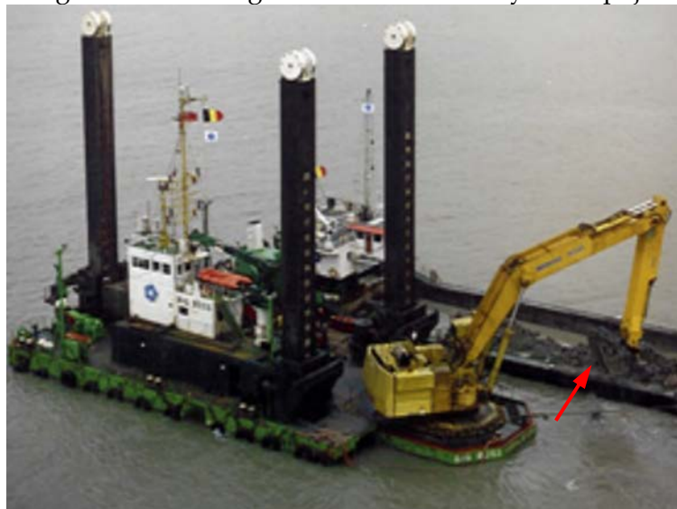
Figura 2.6. Dragadora de retroexcavación y de empuje.
