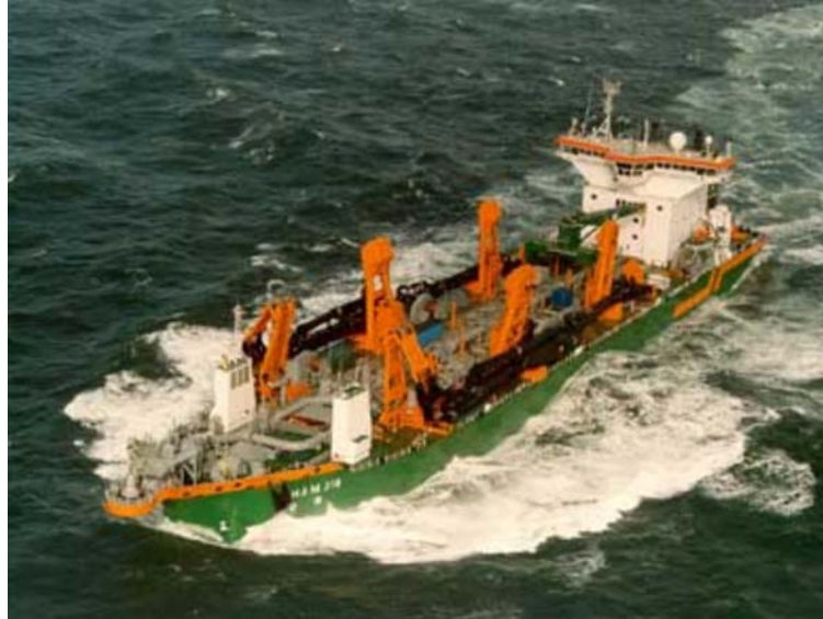
Figura 2.8. Dragadora de succión en marcha o "trailer".
