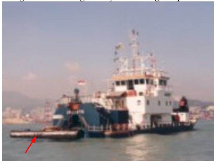
Figura 2.9. Dragadora de inyección de agua a presión.
