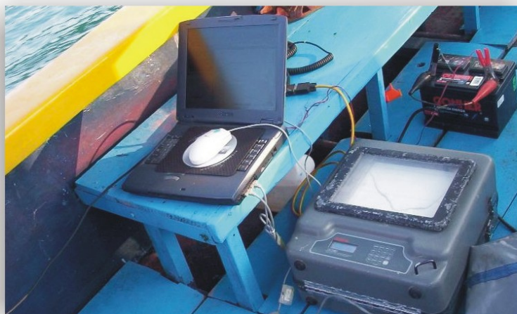
Figura II. 4 Captura de Datos de Ecosonda
