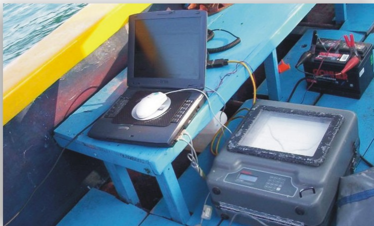
Figura I. 57 Captura de datos de ecosonda
