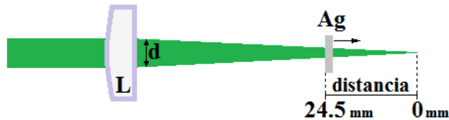
Figura 16. Cambio de la distancia focal, a partir de desplazar 24.5 mm, el blanco de Ag hacia el punto focal (0 mm). El diámetro “d” del área de impacto decrece conforme se avanza hacia el punto focal, debido al empleo de la lente convergente “L”.
