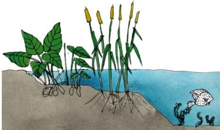
Figura 6-10 Detalle de las posibilidades productivas del jagüey. Es fundamental que se tenga una profundidad mayor a 1.2 m para la recirculación del agua por cambios de temperatura y diferentes niveles para dar oportunidad de crecimiento a diferentes plantas.
