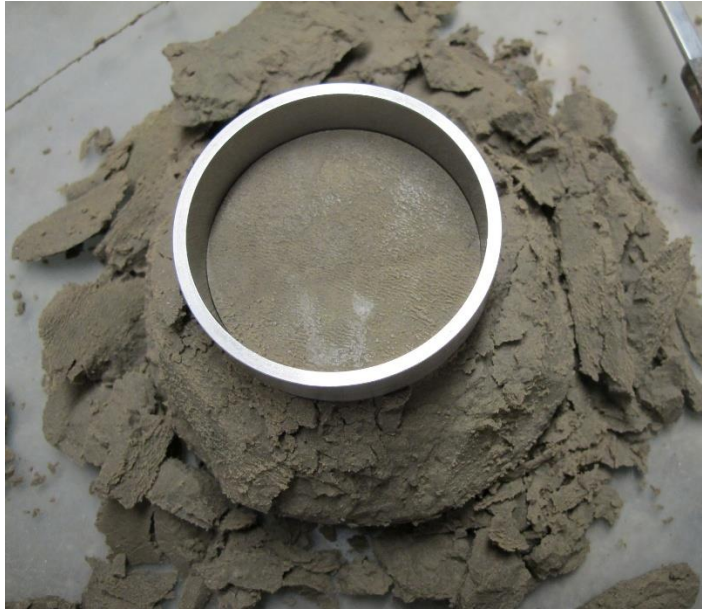
Figura 3.13. Labrado de probeta.
