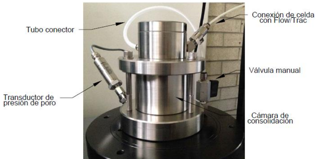
Figura 3.5. Celda de consolidación.
