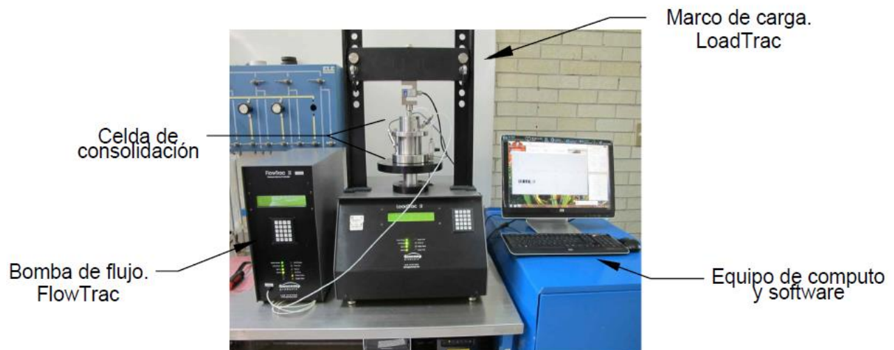
Figura 3.3. Equipo de velocidad de deformación constante, (GeoComp).
