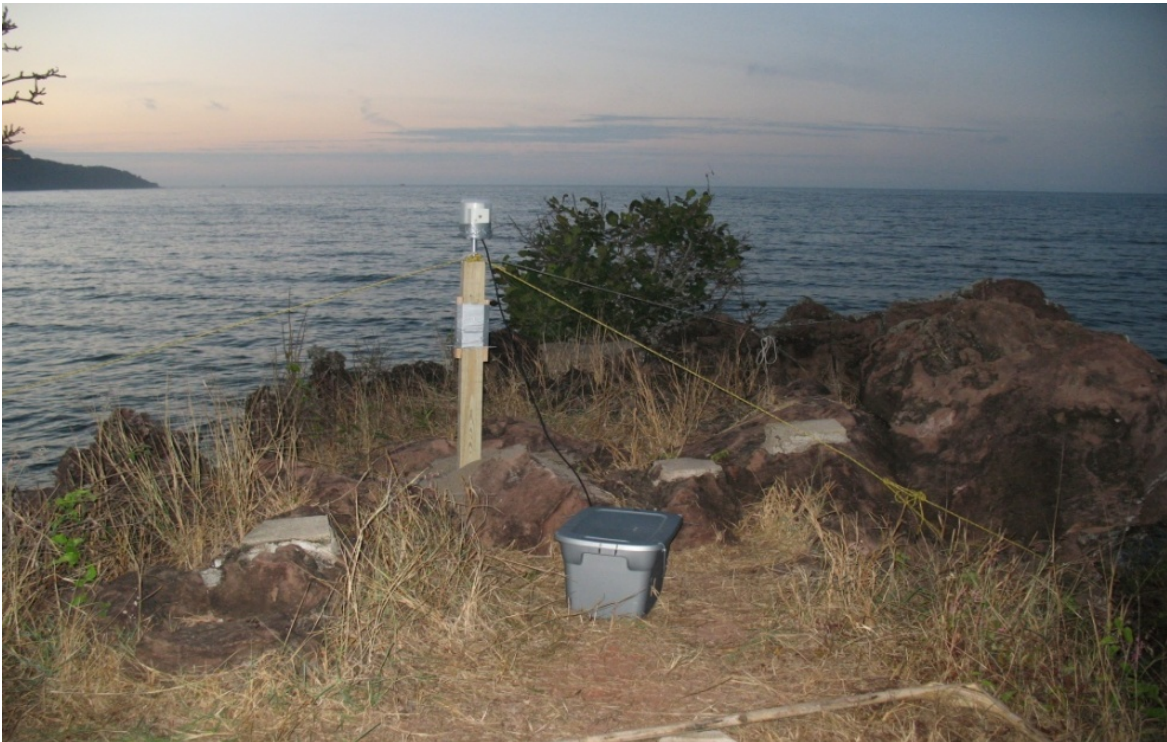
Figura 21. Estación base realizada en Guayabitos, Nayarit con un magnetómetro modelo G856.
