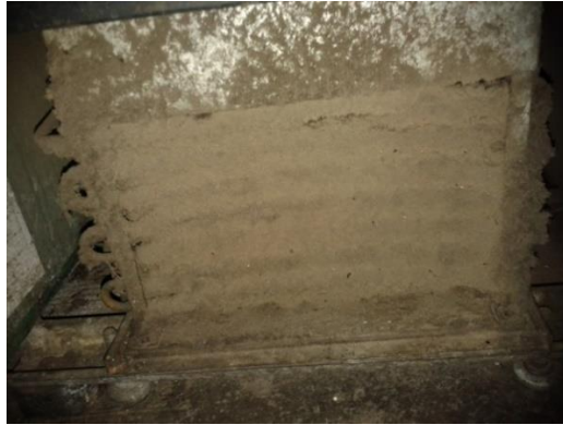
Figura 5 Condensador enfriado por aire de refrigerador de bebidas
